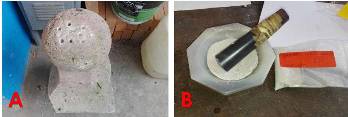
Fig. 53. Proceso de preparación de muestras para análisis de Rayos X en ignimbrita representativa del Pináculo del Centro Cultural de Clavijero. (A) Área de selección para toma de polvo. (B) Molienda de esquirra en mortero de ágata. Fuente Aldo Zamudio Pérez, 2017.
