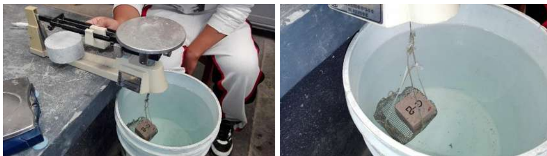
Fig. 39. Proceso del análisis de la densidad aparente (gravedad específica). Fuente. Aldo Zamudio Pérez, 2017.
