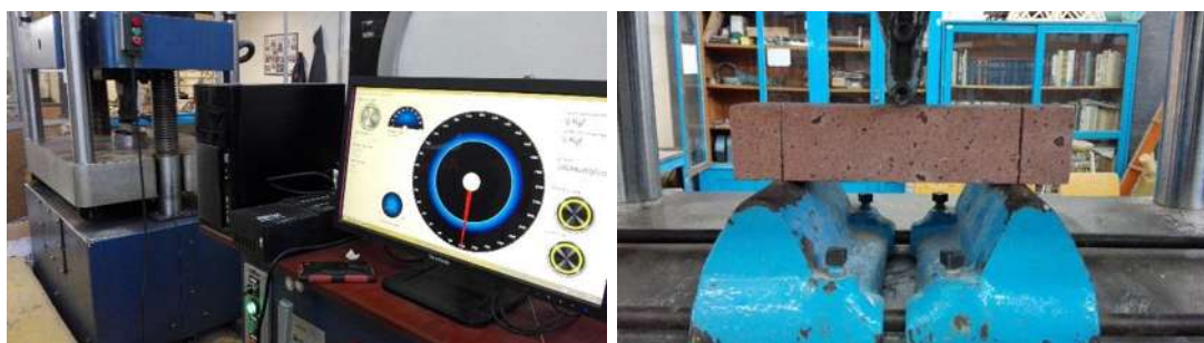
Fig. 43. Proceso del análisis sometiendo la ignimbrita a carga puntual. Fuente. Aldo Zamudio Pérez, 2017.
