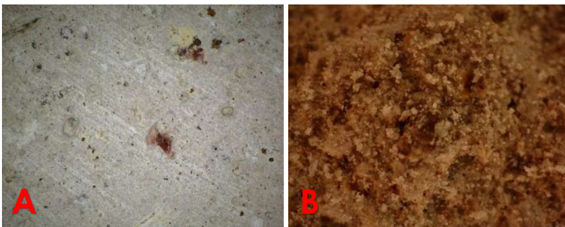
Fig. 57. (A) Heterogeneidad de la ignimbrita de Morelia, muestra de cantería sana del banco del Tejocote. (B) Muestra deteriorada de unidad de análisis calle Morelos 04-M. Fuente Aldo Zamudio Pérez, 2017.
