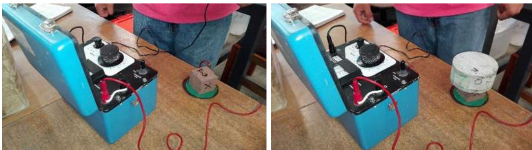
Fig. 47. Proceso del análisis de la resistividad de la ignimbrita. Fuente. Aldo Zamudio Pérez, 2017.
