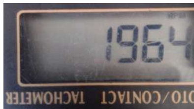
Figura 4.15: Velocidad en RPM obtenido del tacómetro digital del Motor CD a 12 volts.
