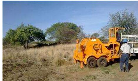
**FIGURA 39.- EQUIPO DE TENSION O TRACCIONADORA**
