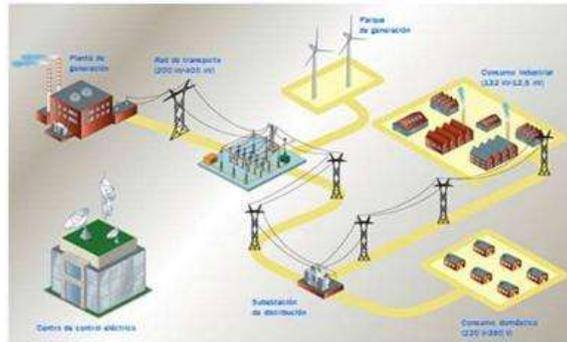
**FIGURA 1.-ESQUEMA DE GENERACIÓN, TRANSMISIÓN, SUBTRANSMISIÓN, DISTRIBUCIÓN Y CONSUMO DE ENERGÍA ELÉCTRICA.**
