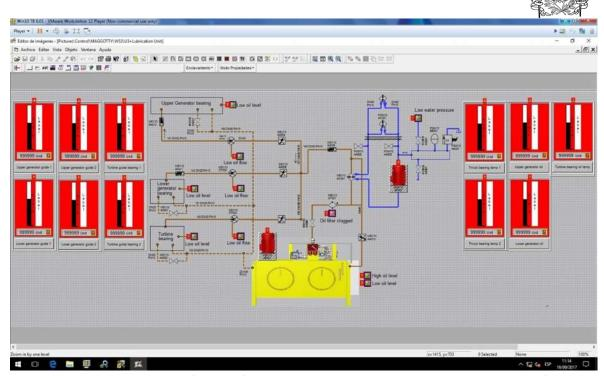
Imagen 3.10 Fabricación de imágenes para la pantalla de una Unidad de lubricación para el proyecto C. H. Maggotty A, en donde se interpreta la unidad de lubricación, sus bombas y sus indicadores de nivel.
