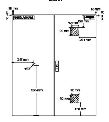
Imagen 5.18 Se muestra la guía para los barrenados del tablero. Guía necesaria en todos los Diagramas de ensamble.
