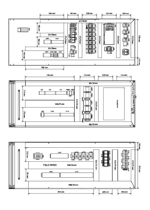
Imagen 4.9 Parte del diagrama de ensamble del proyecto C.H. Maggotty, donde se ilustra la parte interna del gabinete así como la distribución de los equipos dentro de él. Se aprecia en primer lugar el PLC de control, así como sus módulos recolectores de señales. También se distinguen switches, la resistencia calefactora y las clemas receptoras de los equipos de campo.
