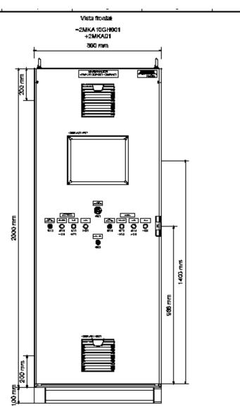
Imagen 5.14 Diagrama de ensamble del Tablero remoto de nivel generador, donde se observa el equipo que lleva sobre su puerta, una touch panel y botonería de control.
