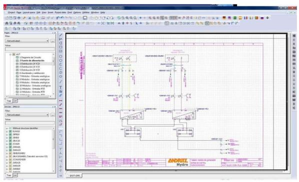
Imagen 3.7. Proceso de dibujo en el programa de ingeniería E-plan, en el que se observan las fuentes de alimentación del circuito y su distribución.
