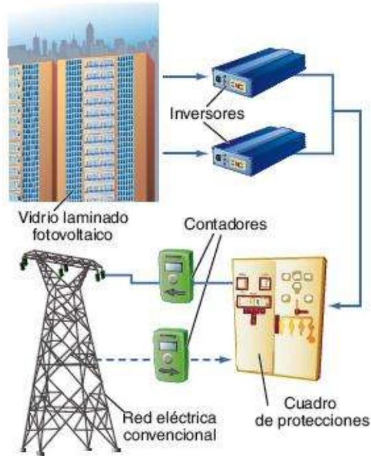
Figura 3.18. Instalación conectada a la red eléctrica
