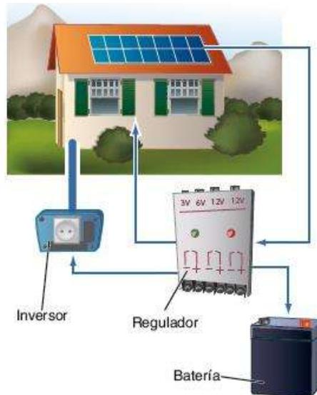
Figura 3.11. Instalación Solar Autosuficiente
