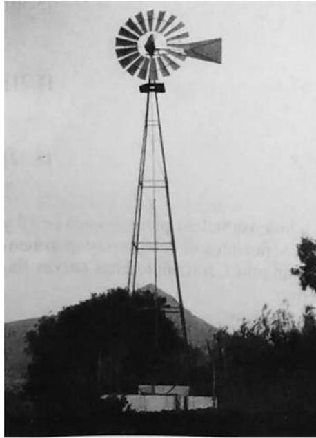
Figura 2.23. Aerobomba multipala o molino americano
