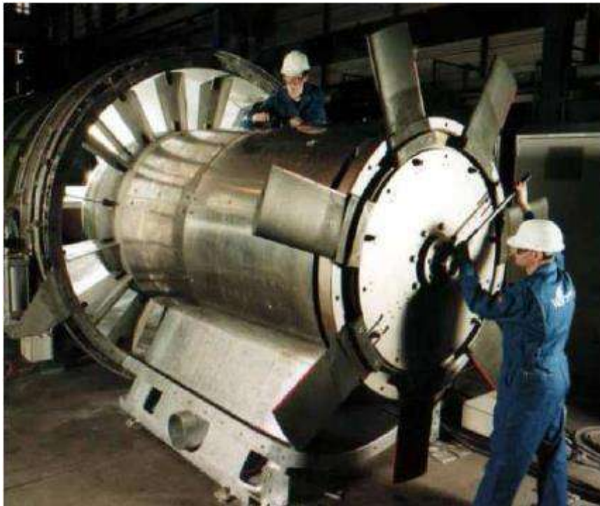
Figura 3. 18.- Turbina Wells bidireccional durante mantenimiento.
