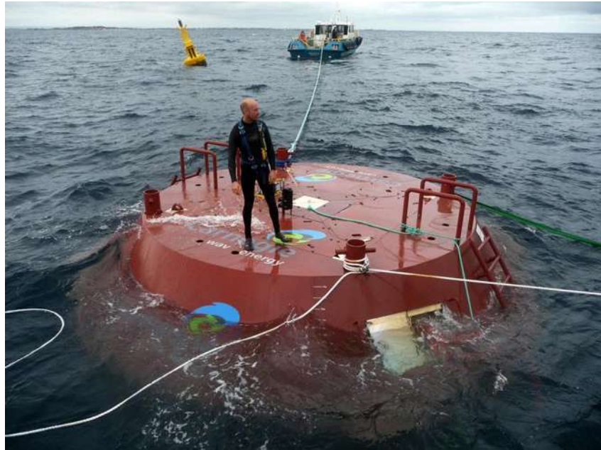
Figura 3. 9.- Dispositivo CETO 5 durante maniobra de mantenimiento.
