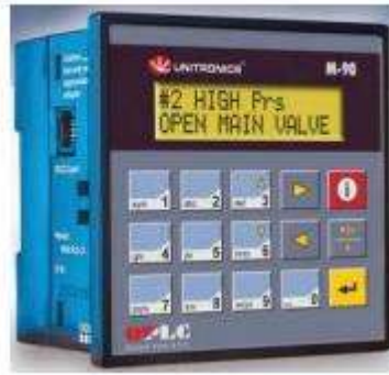
Figura 2.7: PLC con panel operador [5].
