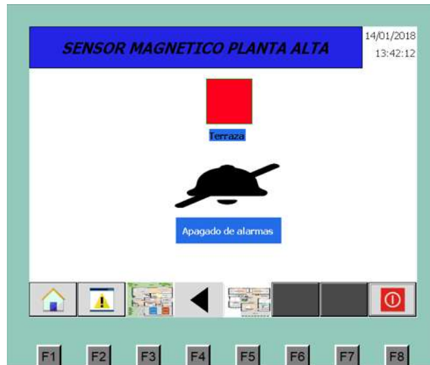
Figura 5.31: Alarma activa sensor magnético planta alta.
