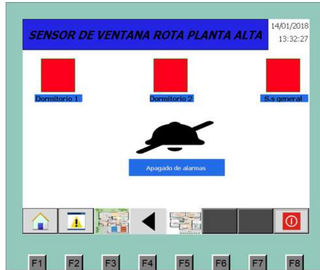
Figura 5. 29: Alarma activa sensor ventana rota planta alta.
