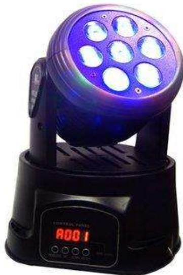
Figura 1.3-1. Cabeza robótica de iluminación LED RGB. [26]
