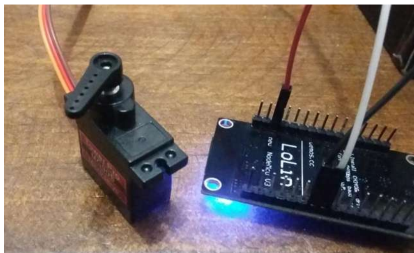
Figura 4.5.2-2 Servo Motor Posicionado a 0°. [84]
