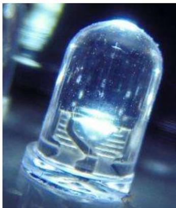
*Fig.\_4. 18. Led que equipa el faro de un automóvil.*
