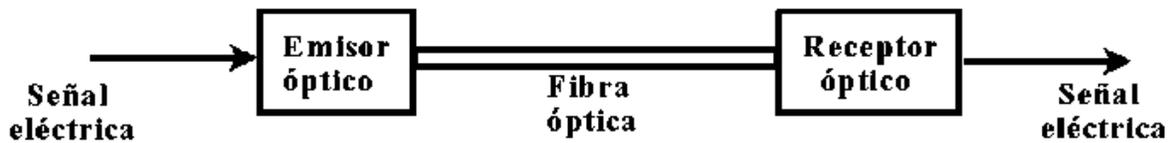
Fig.\_2. 9. Sistema de comunicación por fibra óptica.
