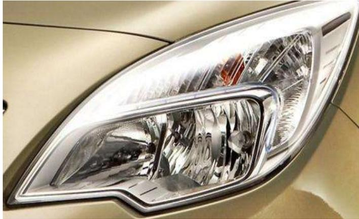
*Fig.\_3. 2. Luces halógenas.*
