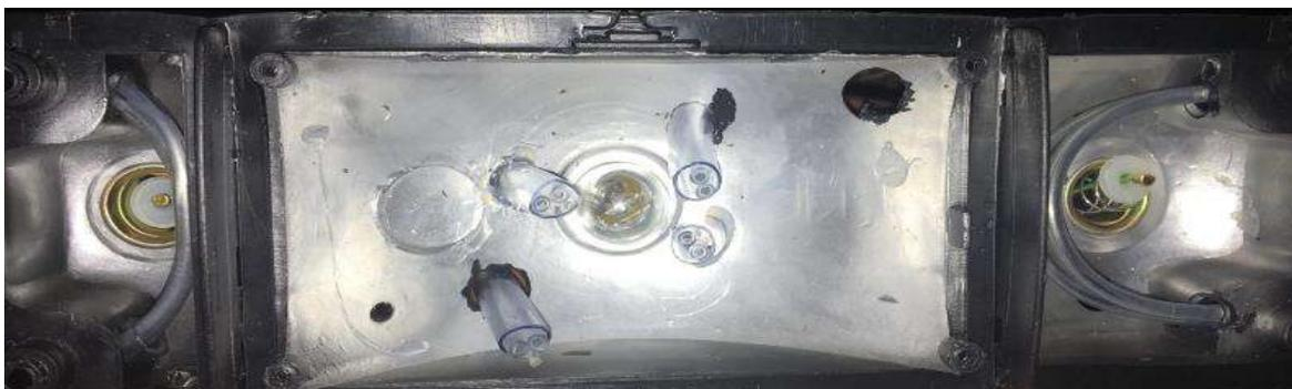
*Fig.\_4.21. Montaje de fibras en la calavera trasera de un auto.*
