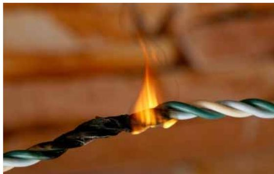
*Figura 2-14 Incendio del conductor por corto circuito [14].*
