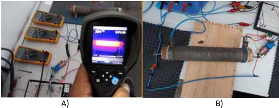
Figura 4-11 Imagen A) registro de temperatura, B) Circuito ejecutado con carga fija de  $40 \Omega$ .
