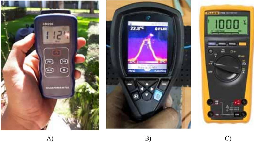
Figura 4-4 equipos de medición A) Irradiación solar, B) Cámara termográfica y C) Multímetro digital.
