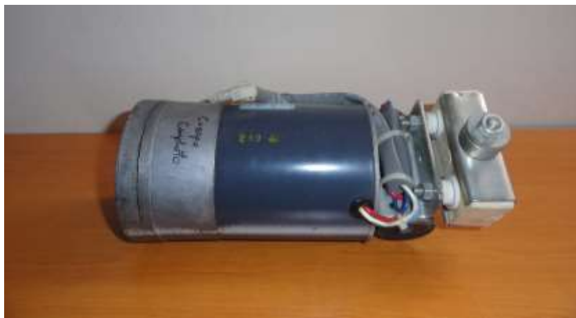
Figura 2.7. Motor de corriente alterna con capacitor de arranque. [11]
