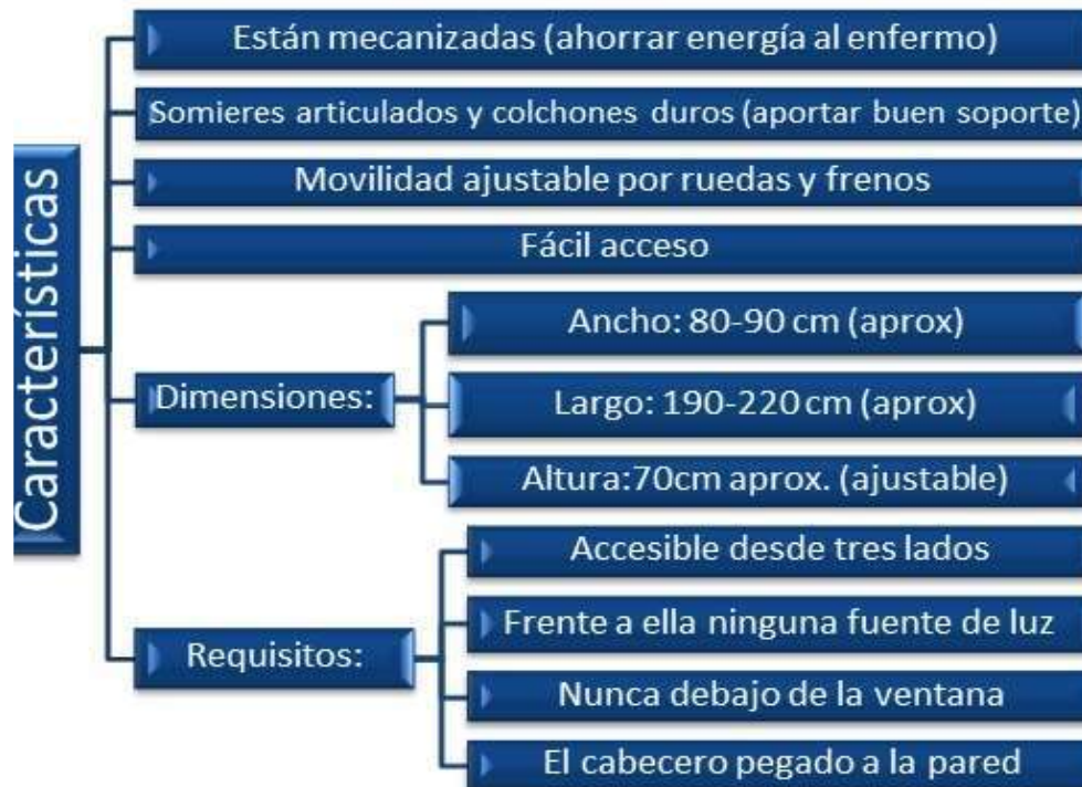
Figura 1.5. Características de una cama eléctrica hospitalaria. [3]
