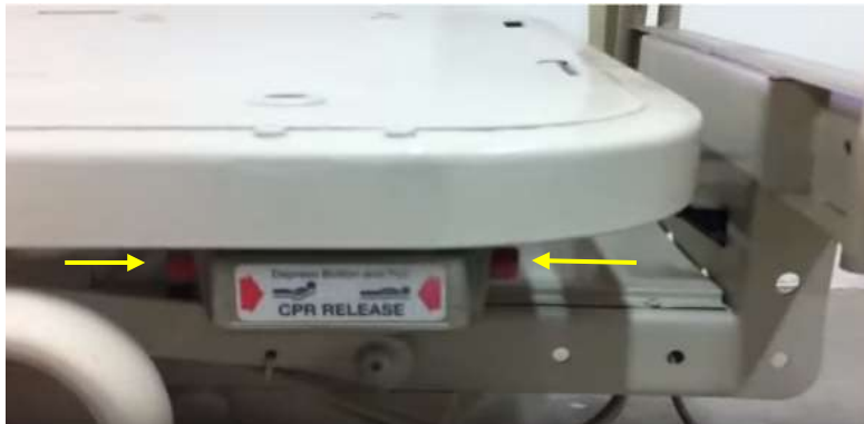
Figura 2.5. Botón de CPR para posicionamiento horizontal. [5]
