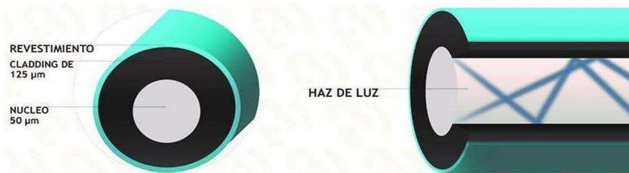
Figura 2. 15 Cable Conexión Multimodo.
