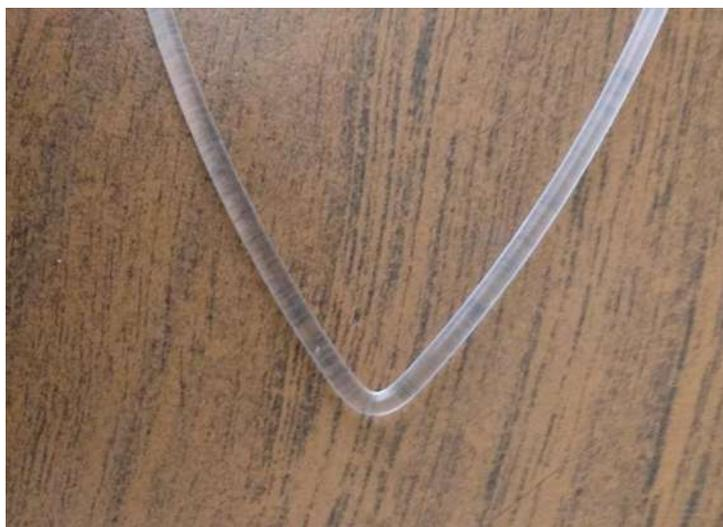
*Figura 3. 27 Fibra Óptica Sin Flexibilidad del Tipo F.O.V.*
