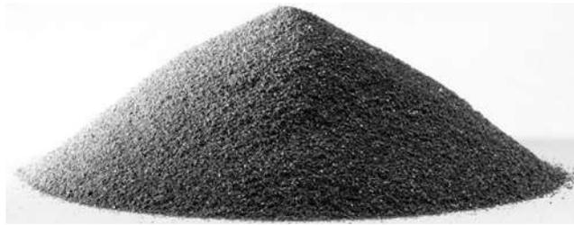
*Figura 2. 19 Mezcla de Bario, Vidrio, Zirconio, Lantano y Bario.*
