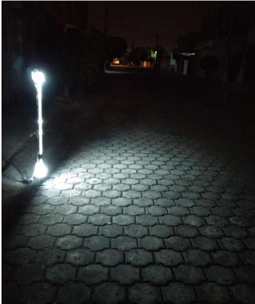
*Figura 5. 4 Sistema de Iluminacion de Alumbrado Público usando Fibras Óptica.*
