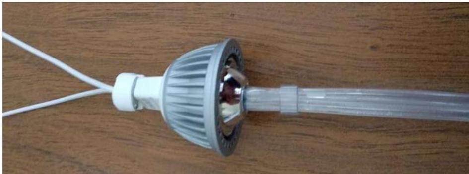
*Figura 3. 31 Fuente de Luz con Agrupación de Fibra Óptica.*
