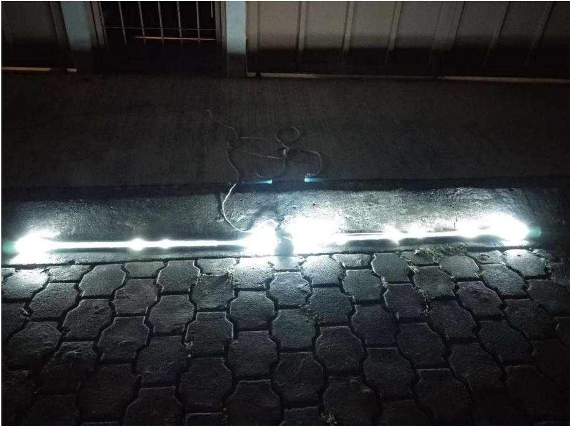
*Figura 5. 1 Sistema de Guías de Luz Sobre Avenidas Usando Fibra Óptica.*
