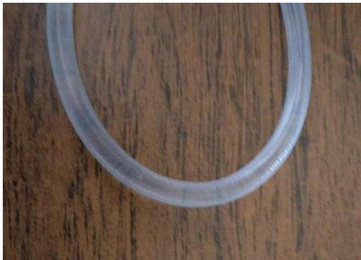
*Figura 3. 26 Fibra ÓpticaFlexible del Tipo F.O.P.*
