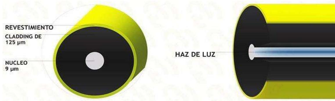
Figura 2. 14 Cable Conexión Monomodo.
