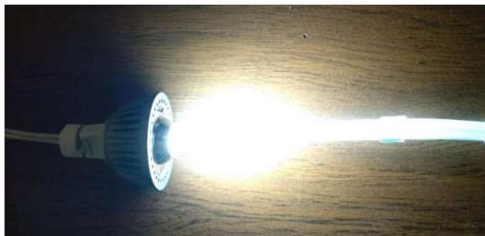
*Figura 3. 38 Emisión de Luz en Agrupación de Fibras Ópticas sin Base Reflectante.*
