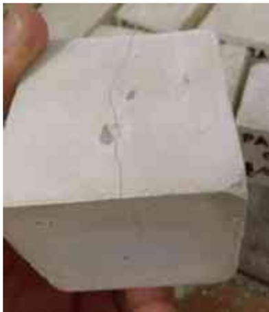
Figura 88. Fisura y hueco en cubo de CC en pasta.
