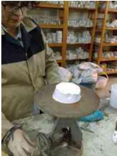
Figura 32. Al remover el molde de un tirón firme.
