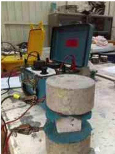
Figura 41. colocación de peso para que no se muevan las placas de cobre durante la prueba
