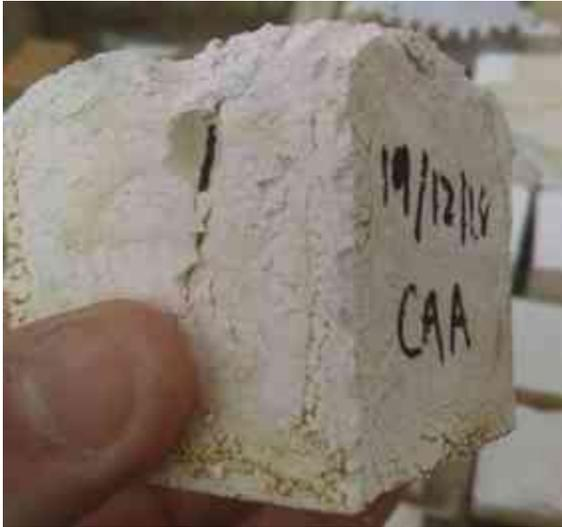
Figura 65. Pasta de CAA con fisura al desmoldarse
