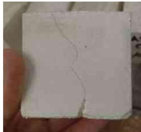
Figura 89. Fisura y grieta en cubo CC en pasta.
