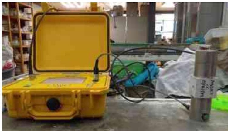
Figura 35. Prueba de velocidad de pulso.
