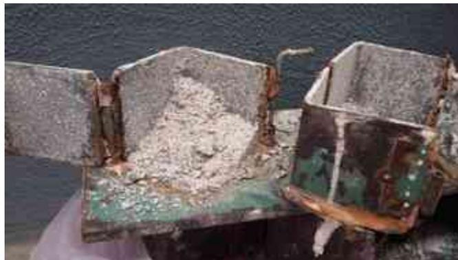
Figura 25. Especímen fracturado en el desmolde a las 24 horas.
