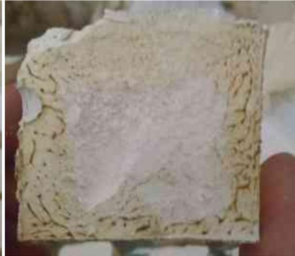
Figura 66. Pasta de CAA, el material se disgrega al desmoldar
