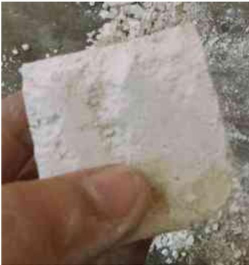
Figura 67. Pasta de CAA disgregándose al desmoldar
