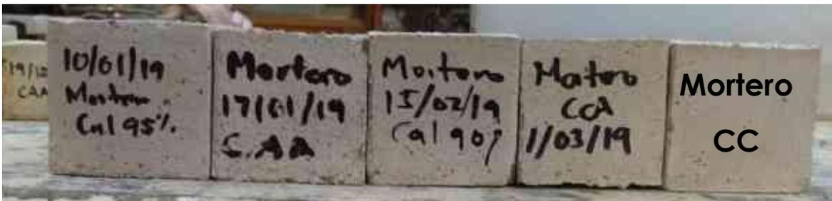
Figura 80. Mortero de las distintas cales
