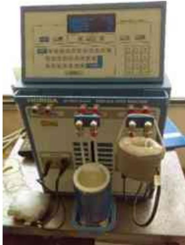
Figura 26. Equipo Modelo Horiba, en el lado derecho de la maquina se utilizaba para secar en material colocándolo dentro de una bolsa térmica.
