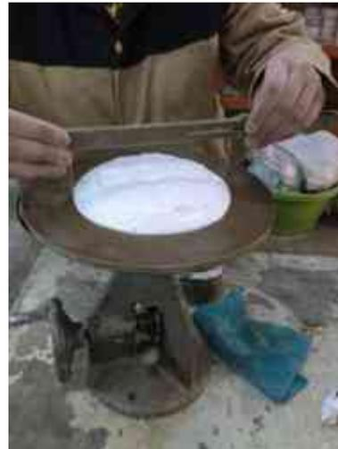
Figura 33. Medición de la fluidez
