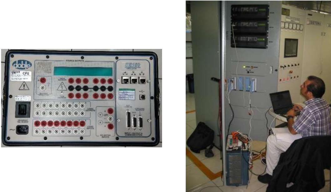
Figura 27.- Pruebas a relevadores de protección con equipo digital Doble-F6150
