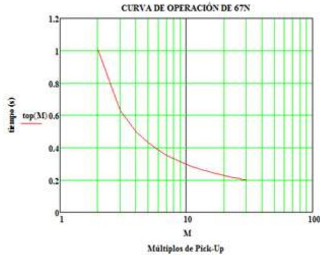
Figura 21.- Curva de operación 67N en la S.E. UPP, obtenido del programa Mathcad.
