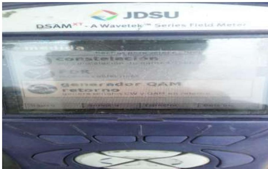
*fig 4.13 generador QAM retorno*
