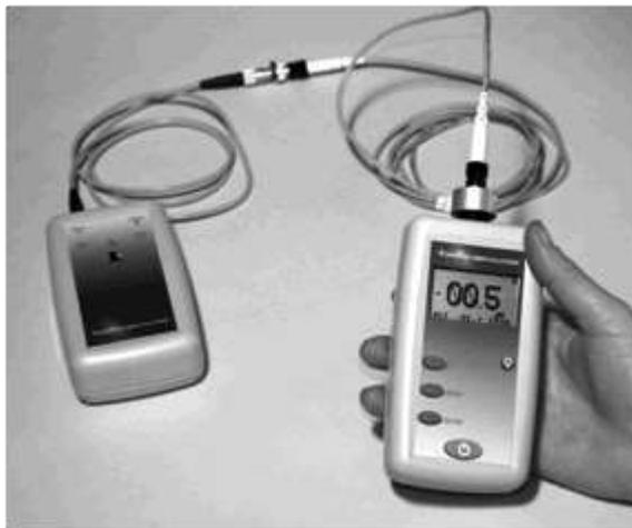
*Prueba de medición de pérdida por conexión[9]*
