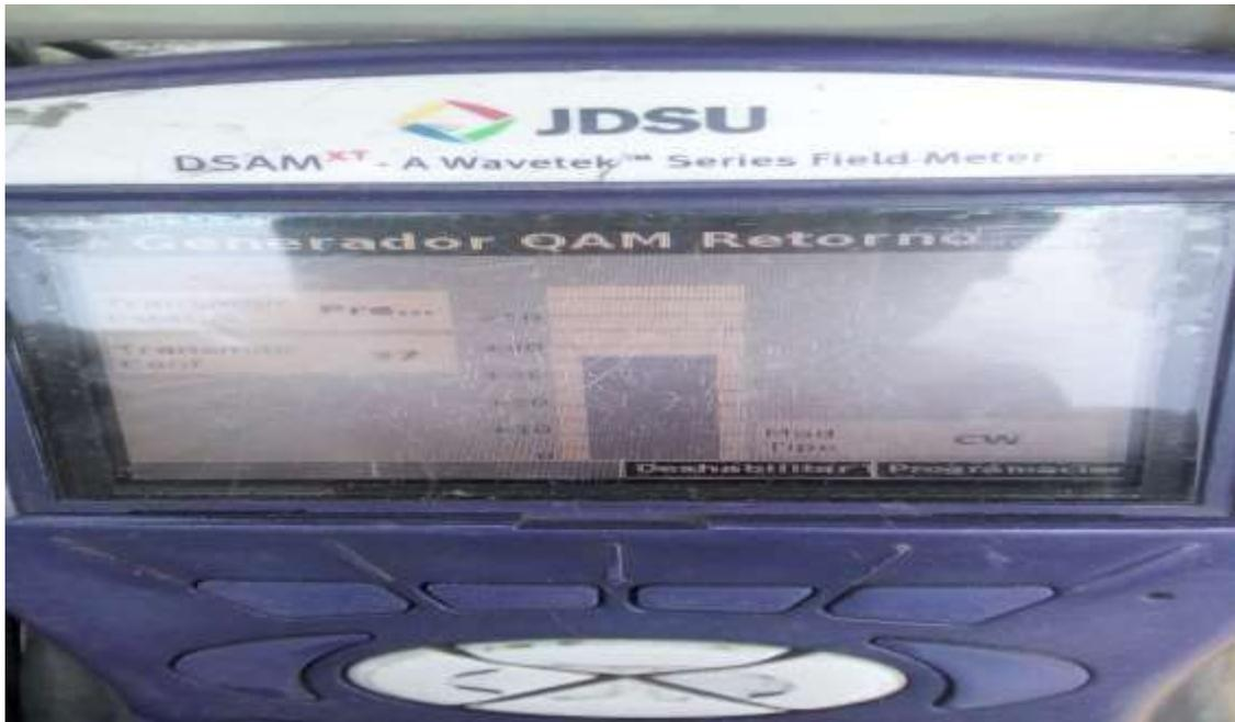
*Fig 4.13.1 barra de generador QAM en retorno*
