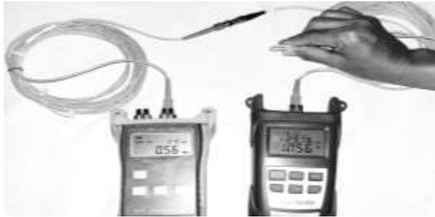
*Figura 4.12 Perturbación dentro del sistema mediante una curvatura en la Fibra Óptica*
