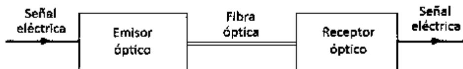
Fig. 2.24 Sistema de comunicación por fibra óptica[8]
