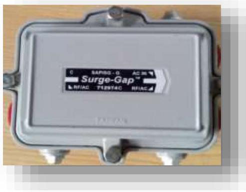
Figura 2.15 insertor de potencia[6]
