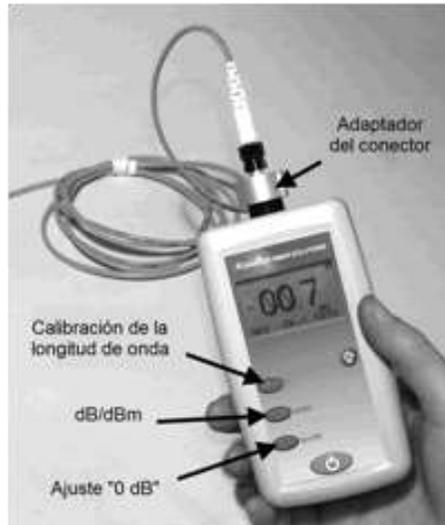
*Medidor de potencia óptica (Power meter)[8]*
