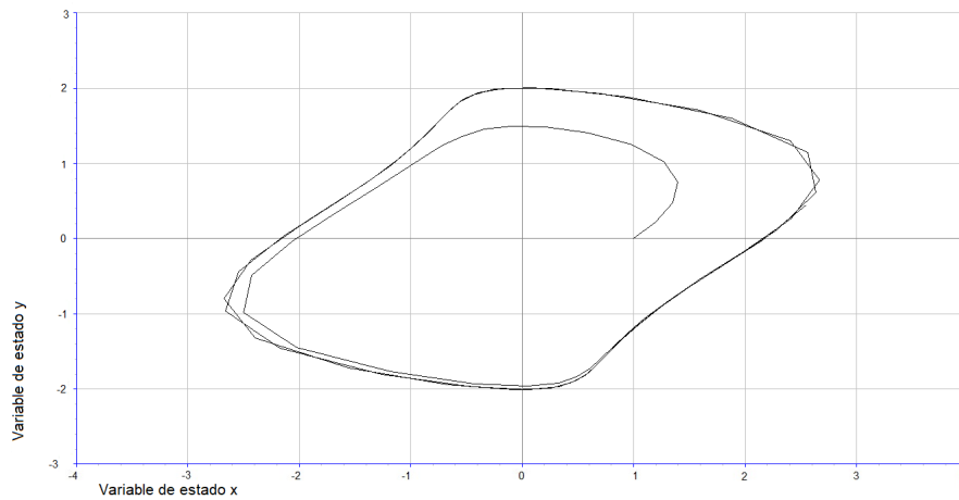
Figura 2.17: Gráfico del plano de fase de la ecuación de van der Pol para a = 1 , b = 1 , x(0) = 1 , y(0) = 0 .
