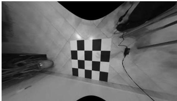
Figura 2.19: Imagen corregida con distancias focales reducidas por un factor de  $1/1.9$ .
