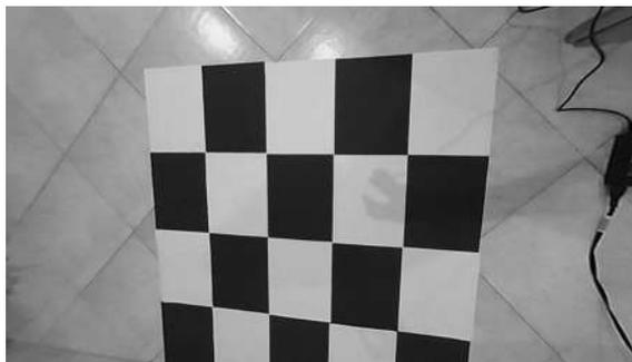
Figura 2.16: Imagen con la distorsión removida.
