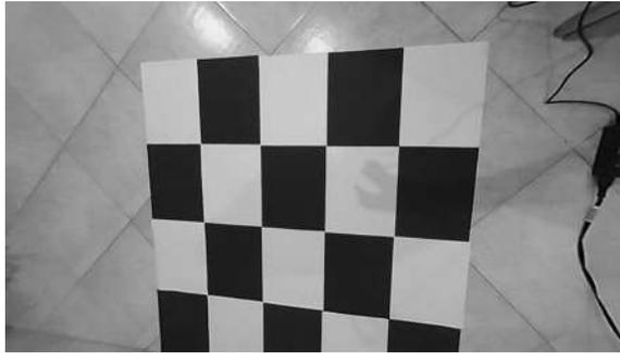
Figura 2.18: Imagen con la distorsión removida con el modelo Fisheye.
