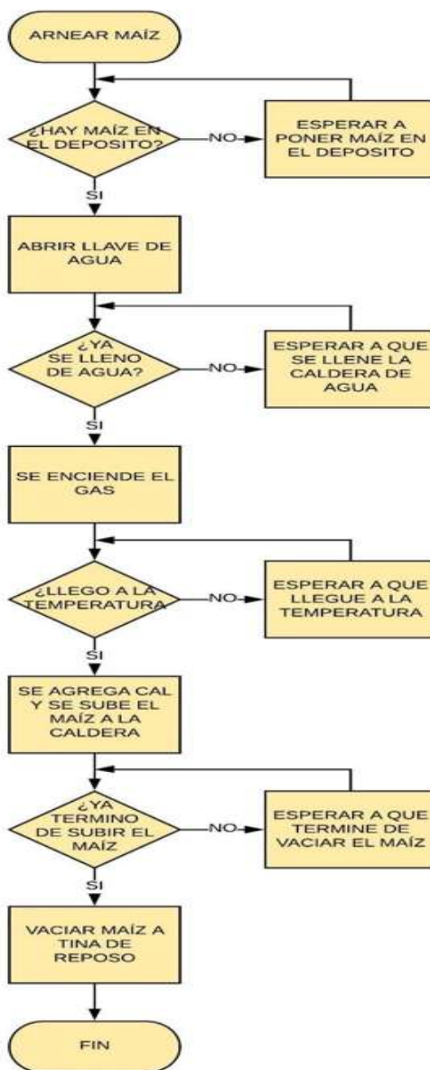
Figura 2. Diagrama de flujo del proceso de nixtamalización
