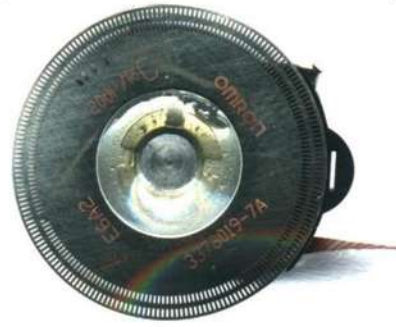
Figura 3.12 Detalle de la lámina perforada
