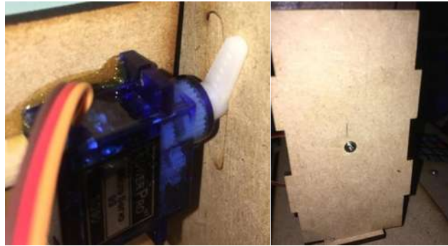
Figura 4.15 Micro Servo 9G atornillado a MDF
