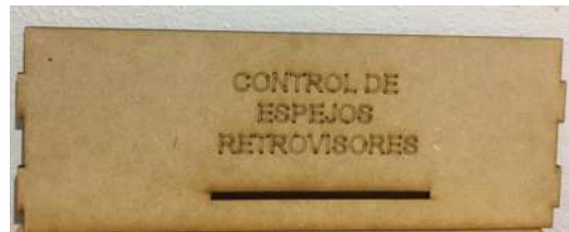
Figura 4.12 Pieza parte de Frente, Diseño y Corte Láser
