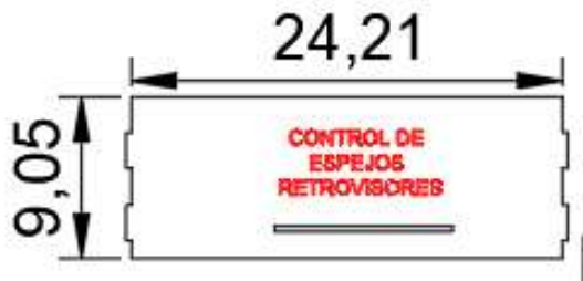
Figura 4.12 Pieza parte de Frente, Diseño y Corte Láser
