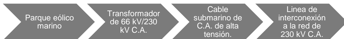
Figura 3.50 Transmisión de energía eléctrica con cable submarino de C.A. para un parque eólico marino.
