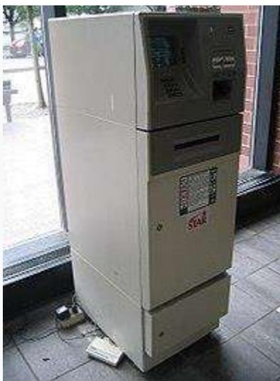
Fig. 1.2 Seguridad de un ATM, Un Diebold 1063ix con un módem de acceso telefónico visible en la base
