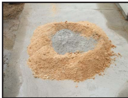
Figura 6.1 Mezcla del aserrín con el cemento.
