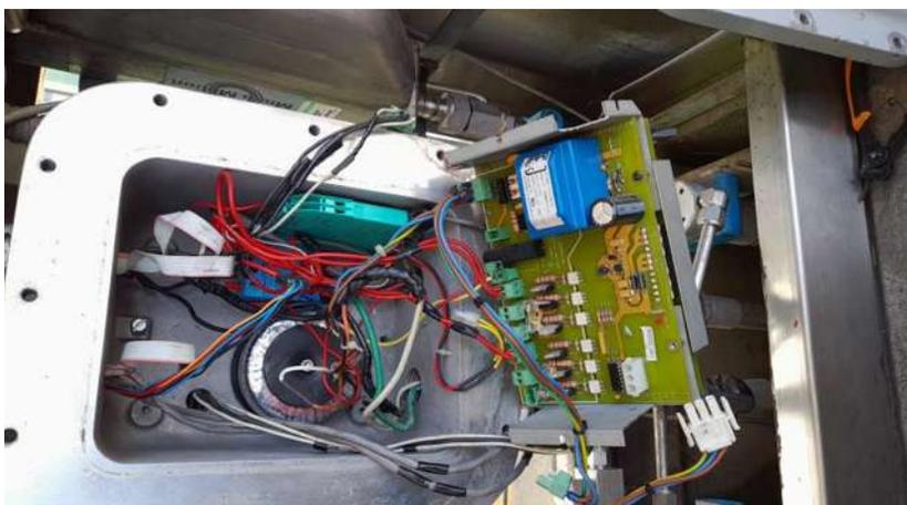
**Figura 5.2** Tarjeta de potencia.
