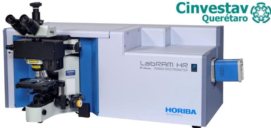
Ilustración 1 Equipo híbrido Raman-PL LabRAM HR Evolution
