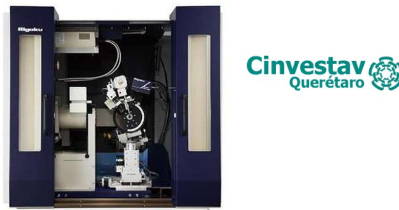
Ilustración 3 Difractómetro RIGAKU Dmax2100
