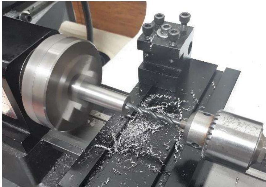
Figura 4.6. Barrenado de cilindros de maraging 300 con broca de 4.5 mm.
