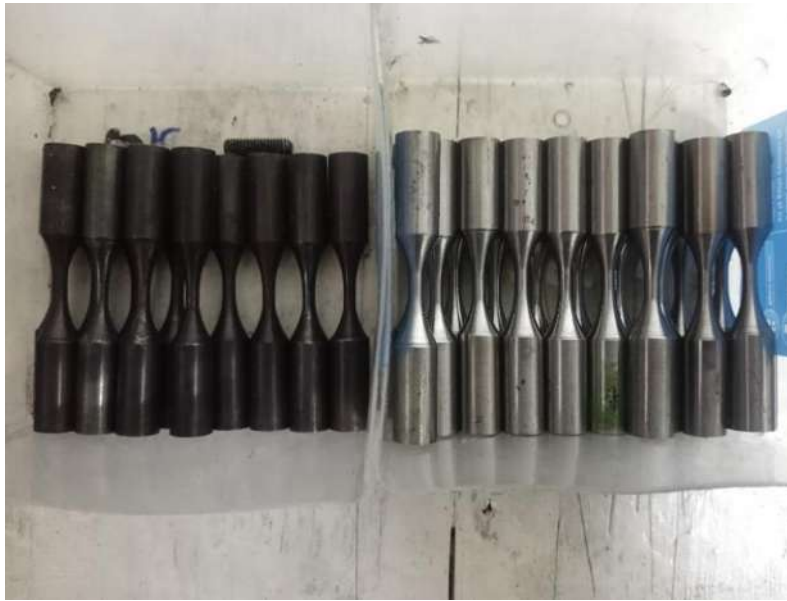
Figura 7.3. Probetas de acero maraging 300 sometidas a tratamiento térmico de envejecido, confrontadas con probetas sin tratamiento térmico.
