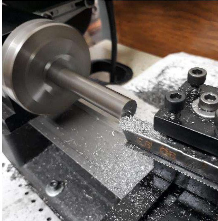
Figura 4.2. Refrentado de probetas de acero maraging 300 para ensayos de fatiga ultrasónica.
