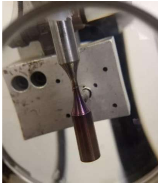
Figura 8.5. Probeta de acero maraging 300 fracturada en el cuello durante fatiga ultrasónica, con temperatura inducida de 200 °C en el cuello.
