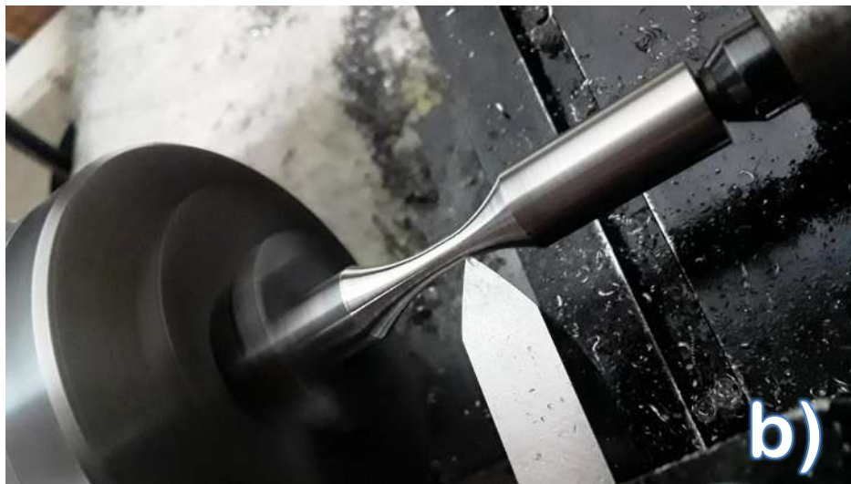
Figura 4.10. b) Perfilado del cuello de las probetas de acero maraging 300 en torno CNC de la FIM, UMSNH.
