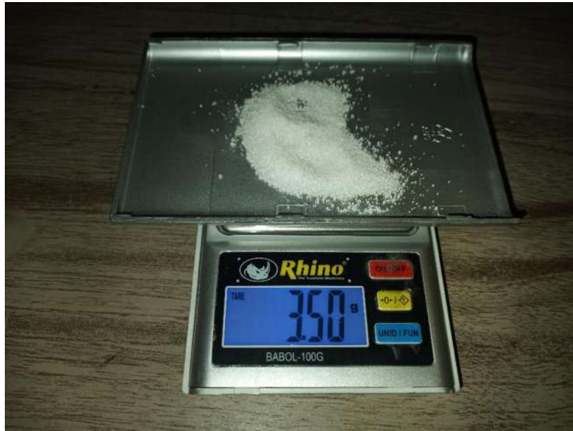
Figura 9.4. Medida de la masa del NaCl (3.5 gramos) para la preparación del agente corrosivo al 35% con agua destilada.
