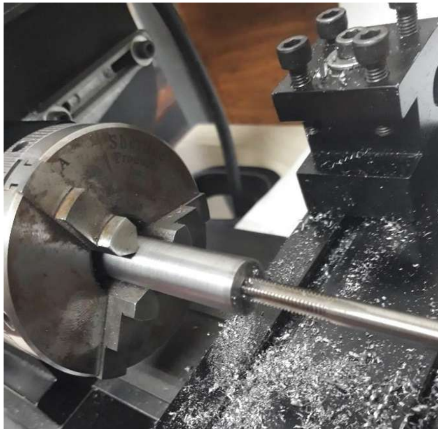
Figura 4.7. Machueleado en barras de acero maraging 300 para hacer una rosca interna de 5mm.
