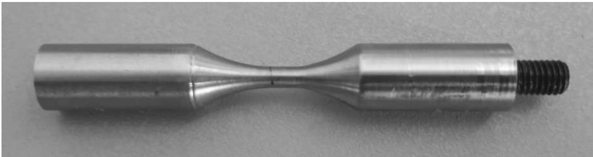
Figura 5.1. Probeta ensayada con fractura por fatiga ultrasónica, acero maraging 300.
