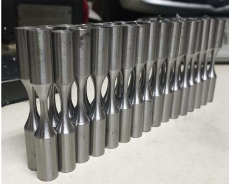
Figura 4.11. Probetas maquinadas y terminadas de acero maraging 300.
