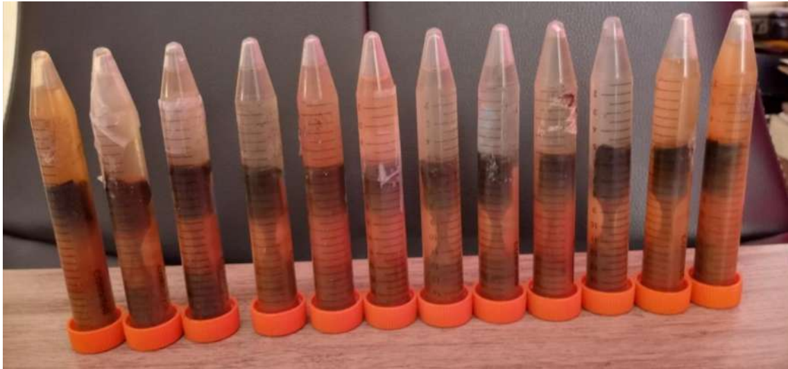
Figura 9.6. Probetas de acero maraging 300 después de una estancia de 30 días bajo ataque corrosivo en NaCl al 3.5 %.
