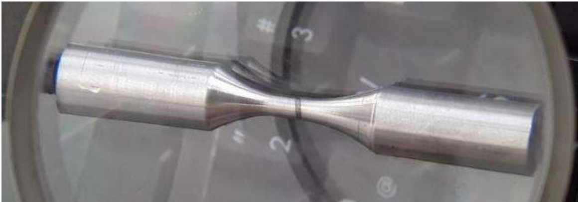
Figura 3.11. Probeta 0 ensayada con fractura por fatiga ultrasónica en la parte central de la muestra, acero maraging 300.
