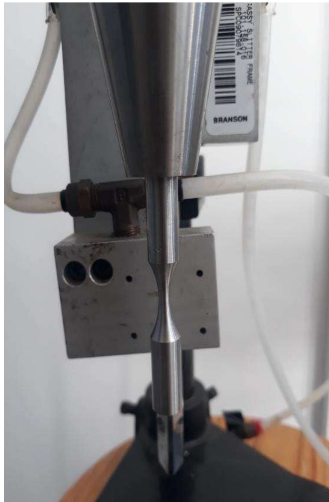
Figura 5.4. Probeta de acero maraging 300, sujeta a la máquina de ensayos de fatiga ultrasónica.
