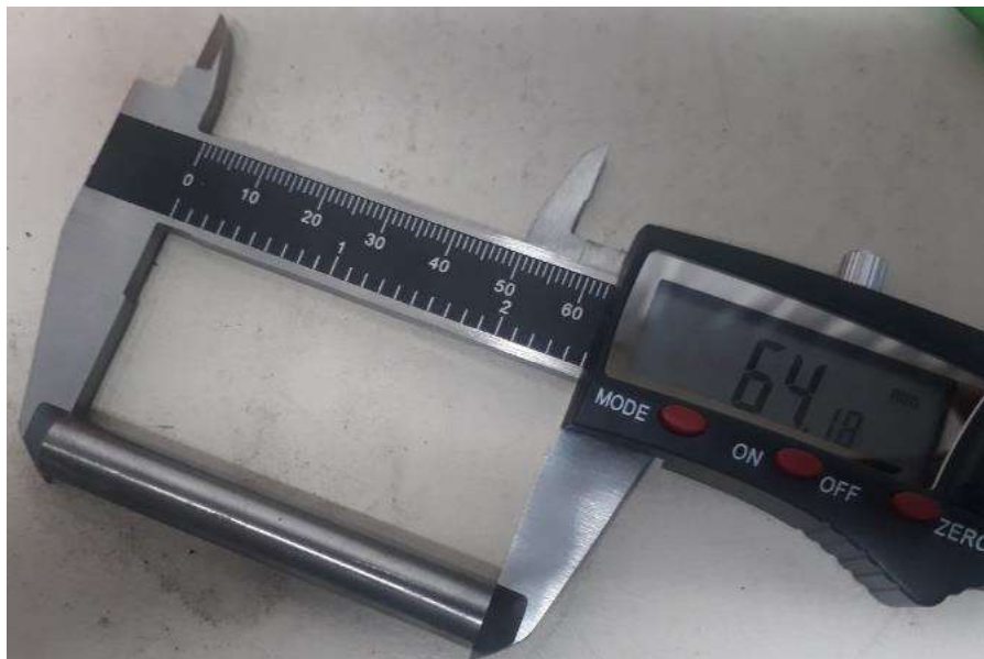
Figura 4.12. Medida de las dimensiones en vernier electrónico de las probetas de acero maraging.
