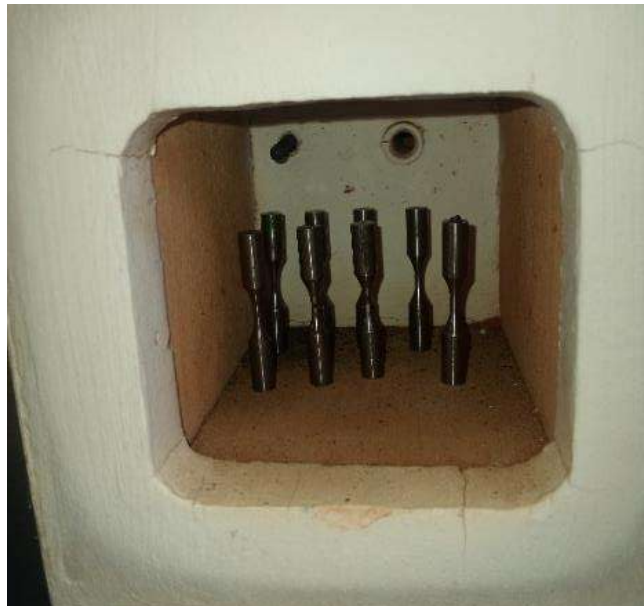
Figura 7.2. Probetas de acero maraging 300 en el horno, para el tratamiento térmico.
