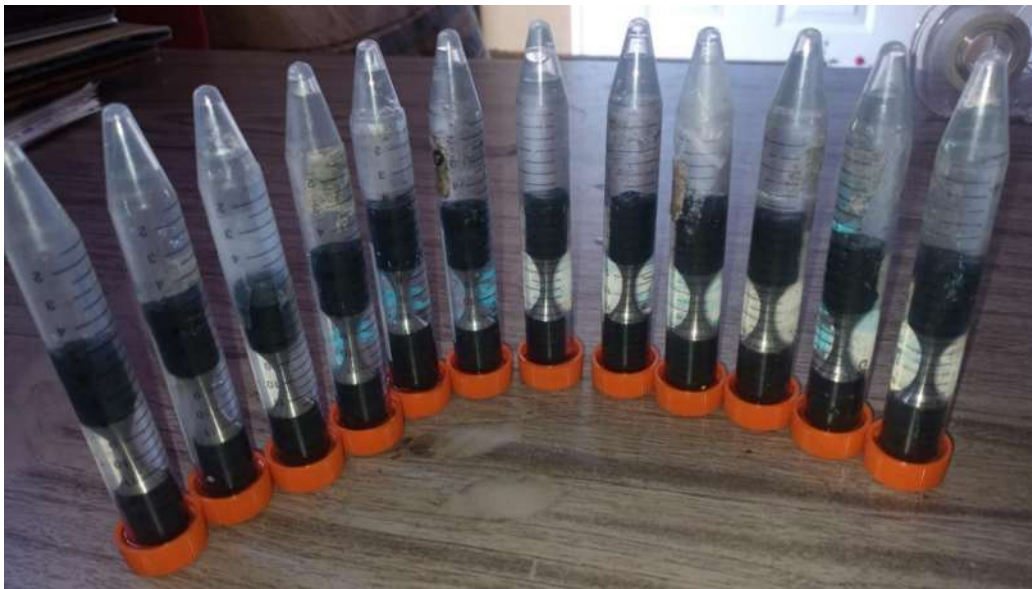
Figura 9.5. Probetas de acero maraging 300, sumergidas en solución corrosiva, mezcla de 3.5 % NaCl.
