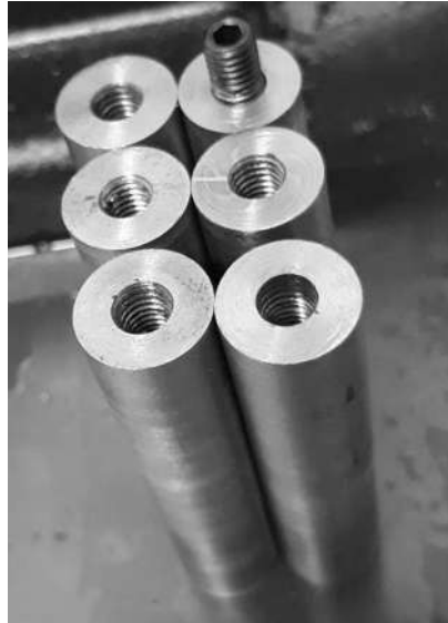
Figura 4.8. Cilindros roscados de acero maraging 300 (manufactura de probetas para ensayos de fatiga ultrasónica).
