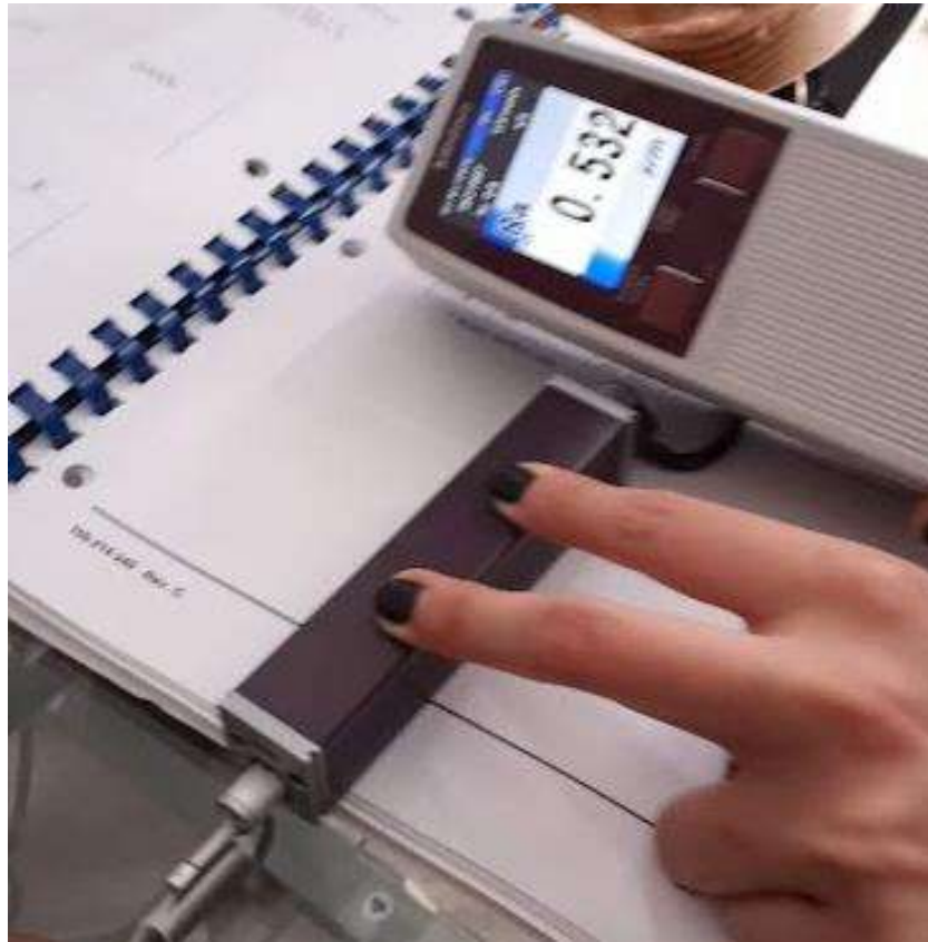
Figura 5.13. Medición del parámetro de rugosidad Ra, en la probeta de acero maraging 300, utilizada en pruebas de fatiga ultrasónica.
