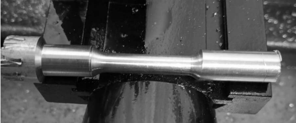
Figura 6.5. Maquinado preliminar en la probeta de aluminio para ensayos en tracción.
