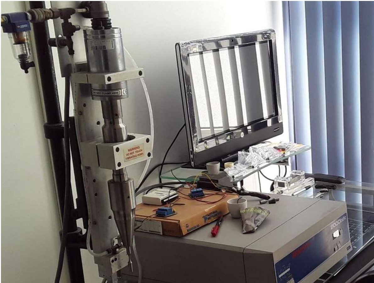
Figura 3.1. Máquina de fatiga ultrasónica, patentada por el Dr. Gonzalo Mariano Domínguez Almaraz No. Patente: 323948.
