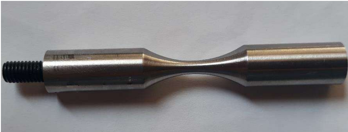
Figura 3.6. Probeta maquinada, acero maraging 300.
