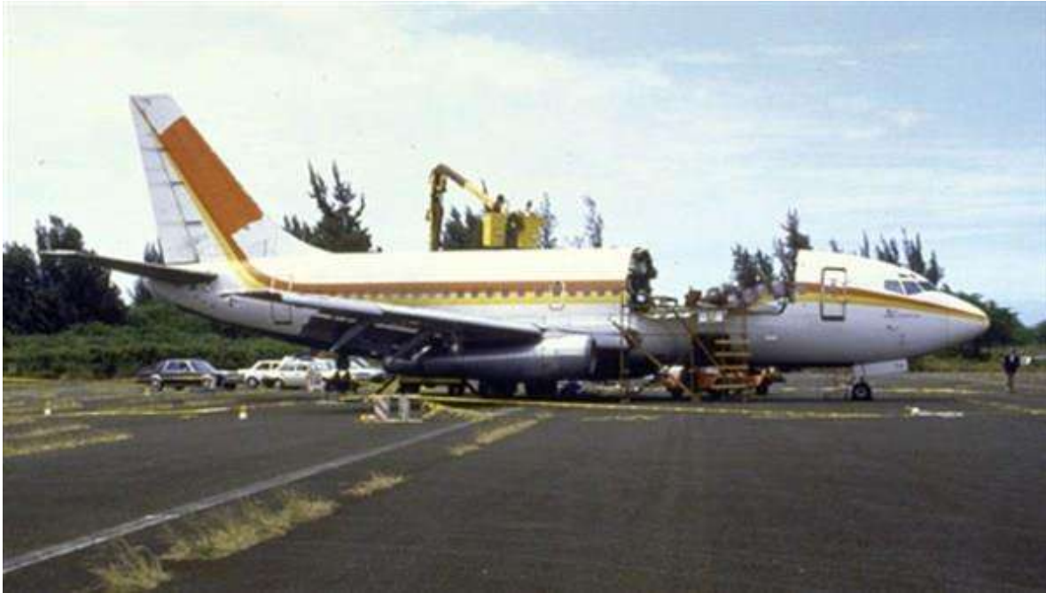
Figura 1.8. Falla por fatiga en un avión comercial (1988) [2].
