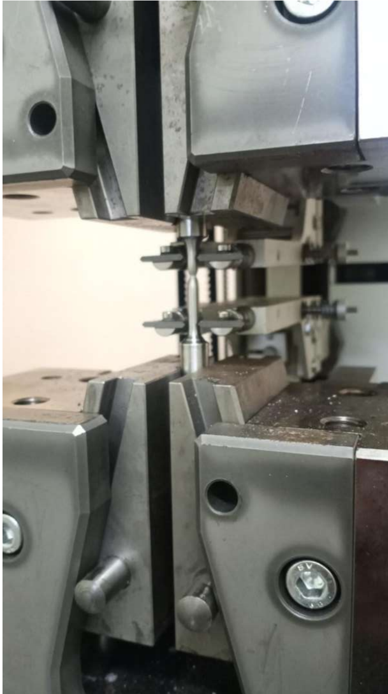
Figura 6.8. Ensayo de tensión poco antes de la fractura de la muestra, IIM, UMSNH.
