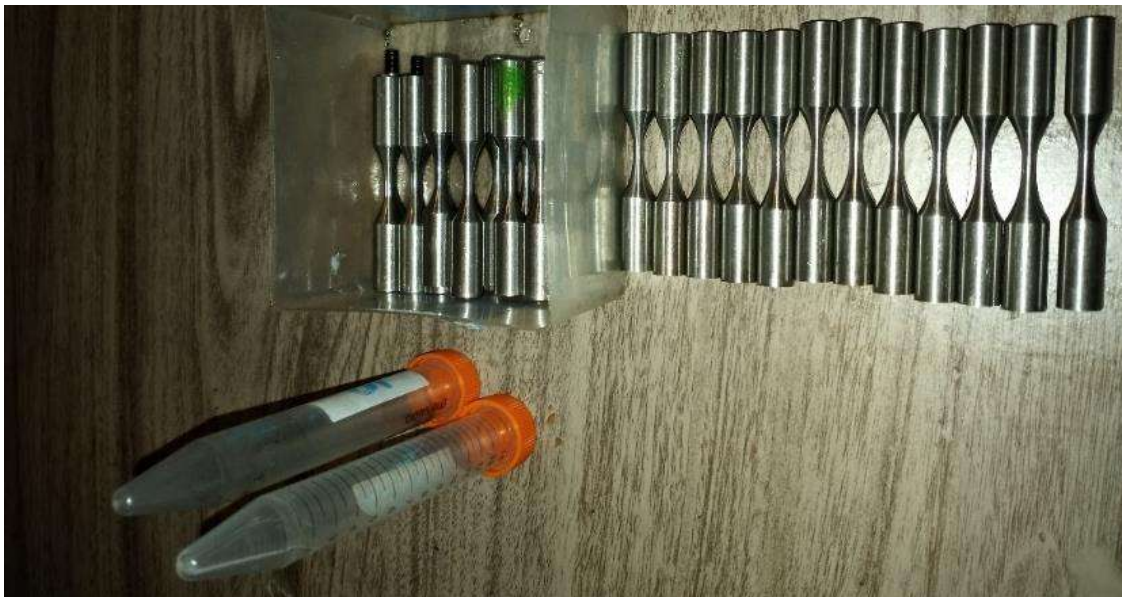
Figura 9.1. Probetas de acero maraging 300 y proceso de pre-corrosión.
