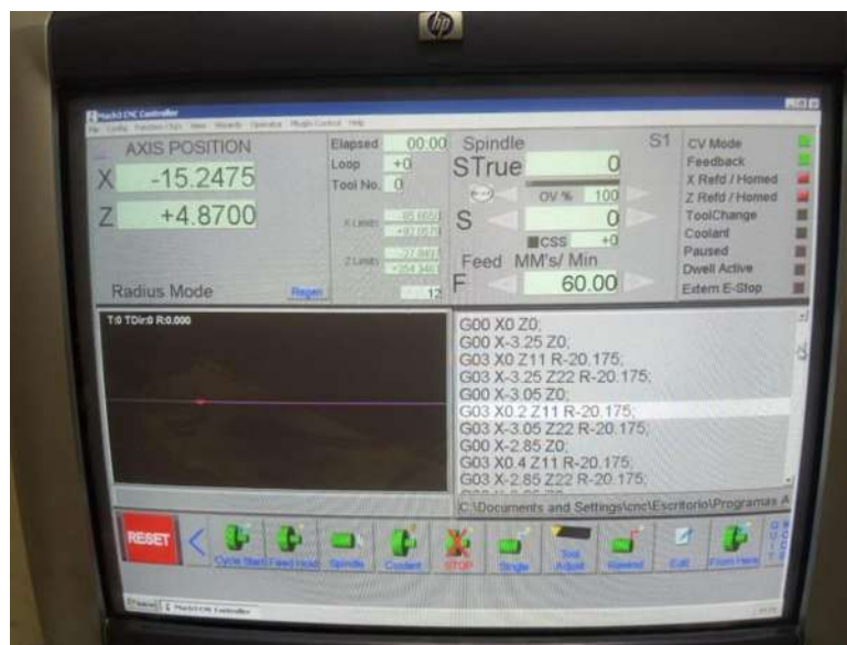
Figura 4.3. Interfaz del programa G de control Mach3 del torno CNC (FIM, UMSNH).
