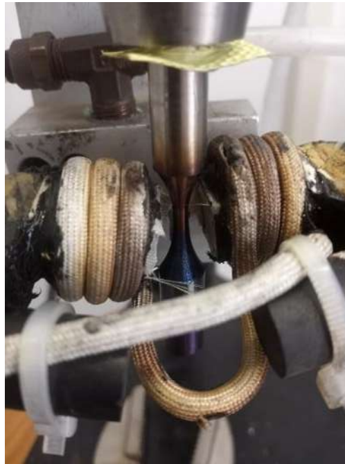
Figura 8.3. Montaje de la probeta de ensayo de acero maraging 300 en la máquina ultrasónica, rodeada por las bobinas de inducción electromagnéticas.
