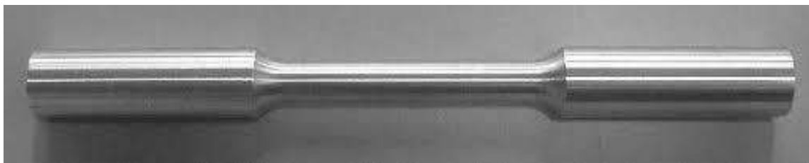
Figura 6.6. Probeta del acero maraging 300, para ensayos de tracción.
