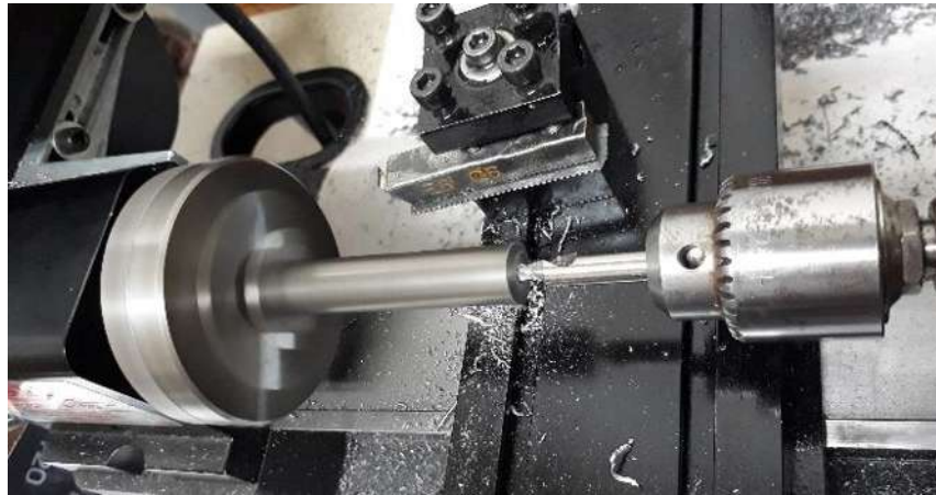
Figura 4.5. Maquinado con la broca de centros, en las probetas de acero maraging 300.
