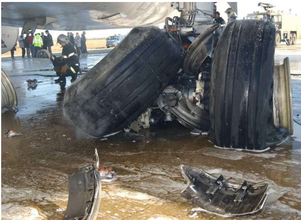
Figura 2.1. Falla en el tren de aterrizaje de un avión.
