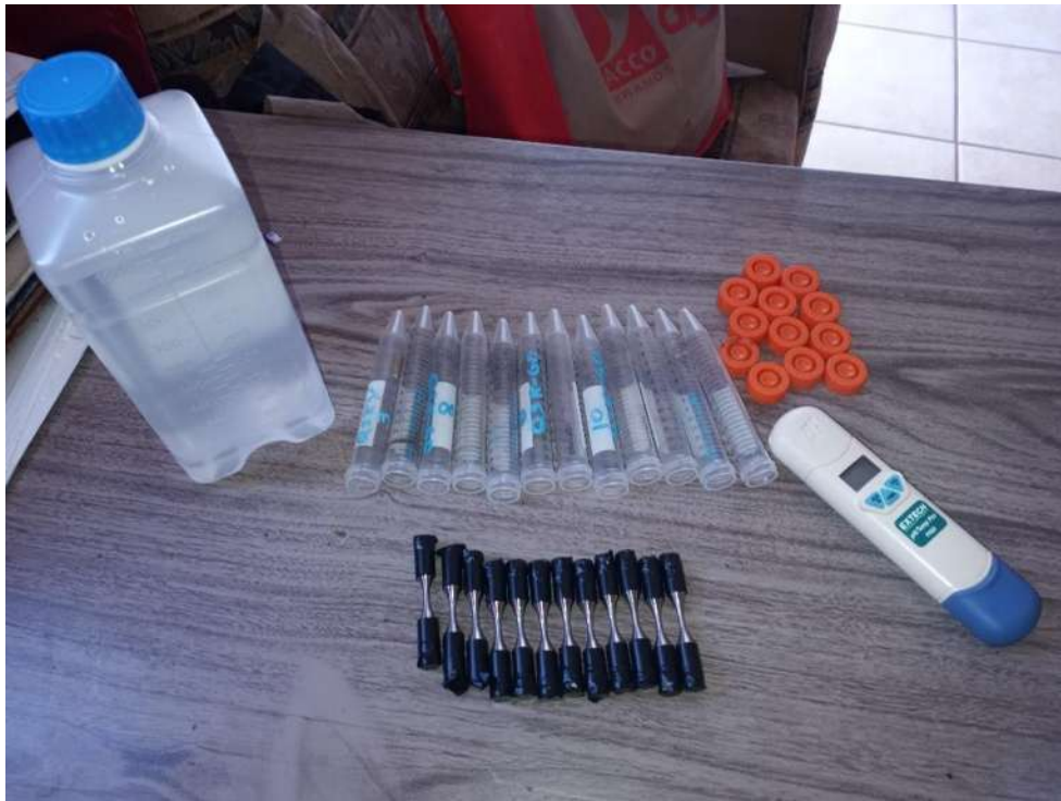
Figura 9.3. Preparación de las muestras de acero maraging 300 para someterlas a pre corrosión.
