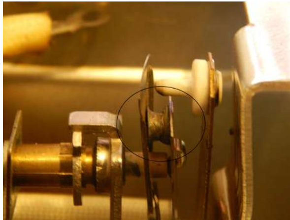
(a) Platinos fundidos del termostato del horno eléctrico.
