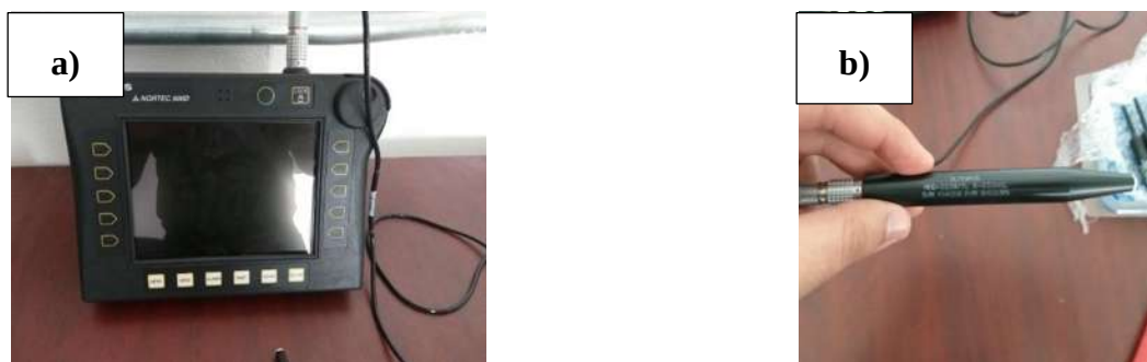
Fig. 3.9. a) Equipo NORTEC 500 D marca OLYMPUS y b) sonda tipo lápiz.
