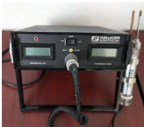
Fig. 3.11. Equipo de ensayos no destructivos Thermo-Sorter Walker Scientific Inc. Con electrodo de punta de cobre.
