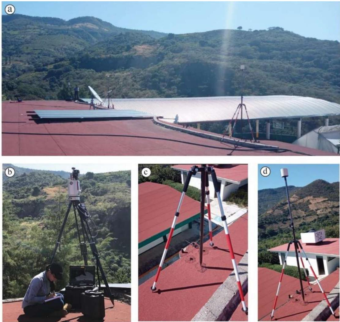
*Figura 18. Imágenes de campo de Jungapeo. a), b), d) reflectores utilizados en campo. b) escáner laser terrestre. c) tornillo que se coloca en un punto fijo, y se colocan los reflectores en el mismo punto.*
