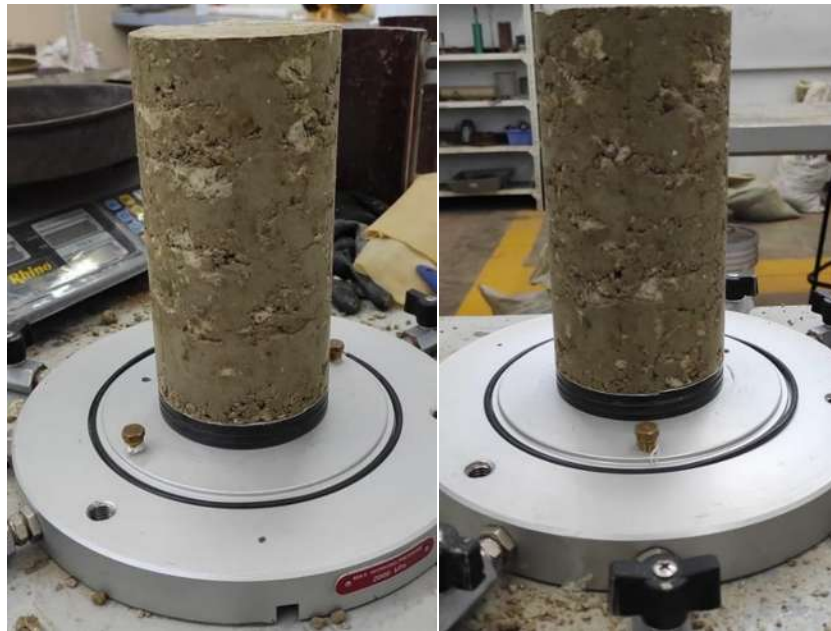
Figura 17.-Espécimen “Choy” sin estabilizar.
