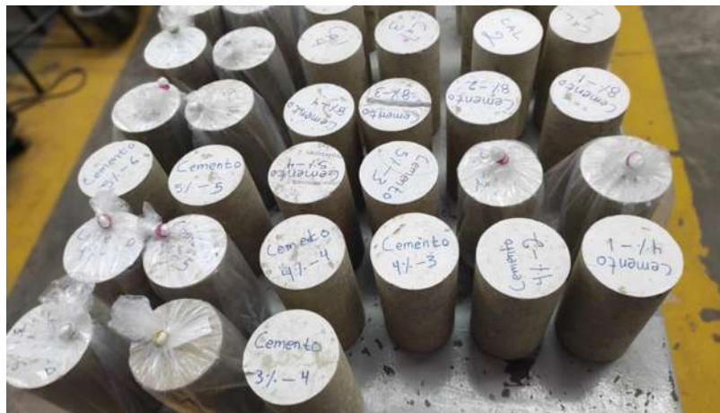
Figura 16.- Especímenes “Choy” ensayados en esta investigación.
