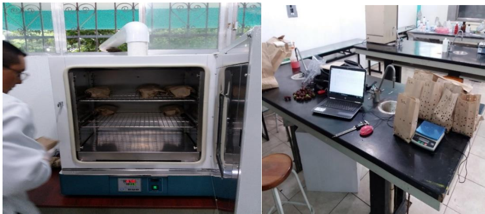
Figura 19 Proceso de secado de los frutos en estufa eléctrica.
