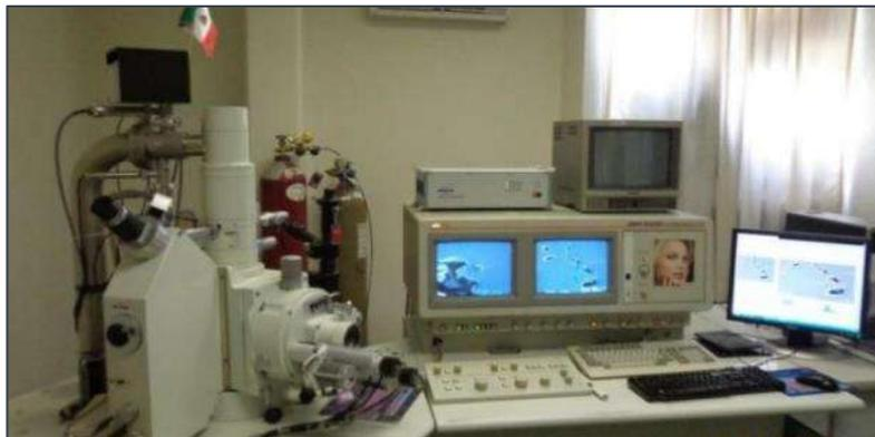
Ilustración 5-10 Microscopio electrónico de barrido JEOL Scanning Microscope JSM-6400.
