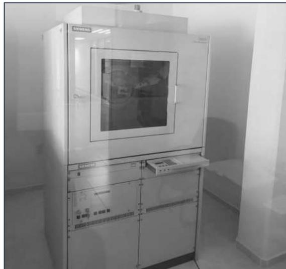
*Ilustración 5-7 Difractómetro de rayos X SIEMENS modelo D-500.*
