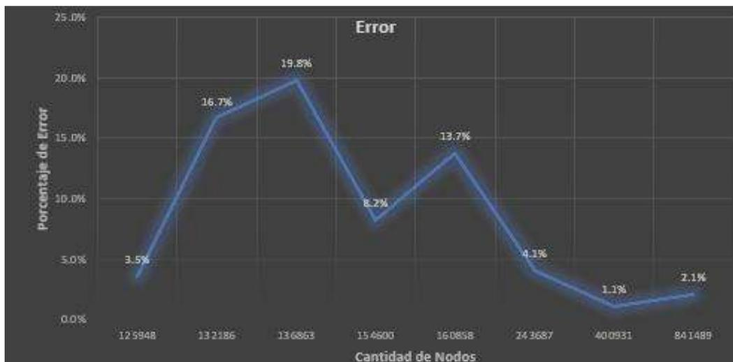
**Figura E1.** Porcentaje de error entre corridas refinando la malla para el eje EPN02.
