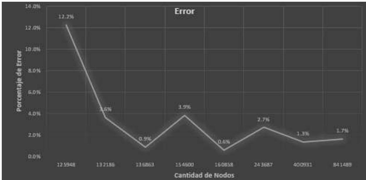
**Figura E3.** Porcentaje de error entre corridas refinando la malla en la esquinade la ranura del eje EPN02.
