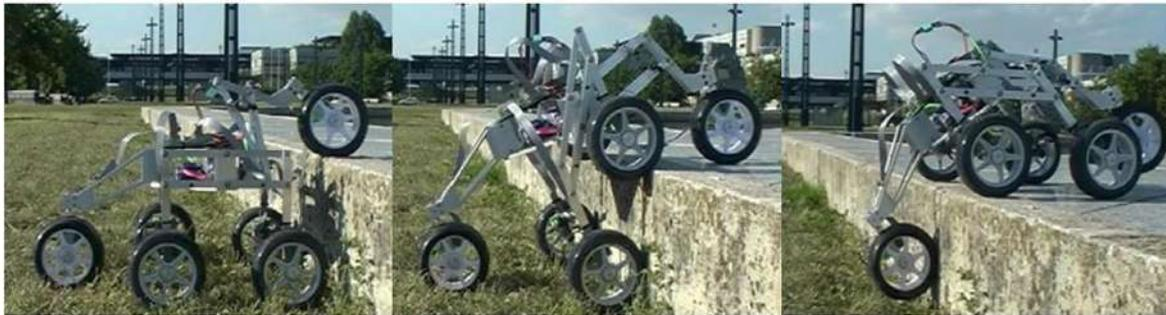
**Figura 14.** Shrimp de EPFL, secuencia de escalado para un escalón de 22 cm de alto (el doble del diámetro de sus ruedas)[9].
