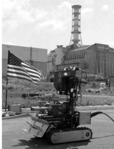
**Figura 5.** Foto del Pioneer, un robot diseñado para explorar “el Sarcófago” en Chernóbil © Wide World Photos.
