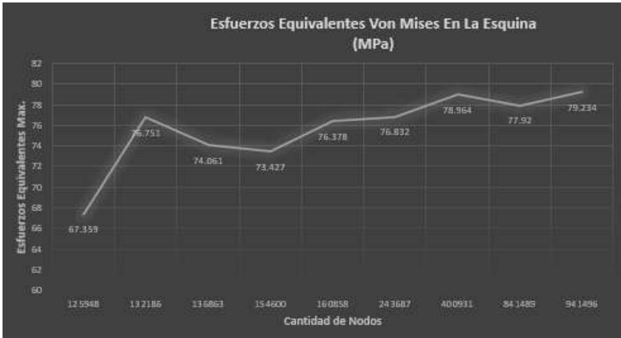
**Figura E4.** Esfuerzos equivalentes Von Mises refinando la malla en la esquina de la ranura del eje EPN02.
