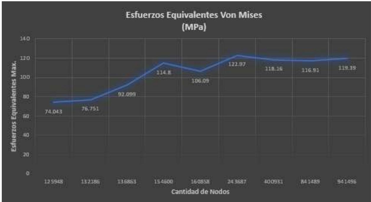
**Figura E2.** Esfuerzos Equivalentes Von Mises refinando la malla para el eje EPN02.
