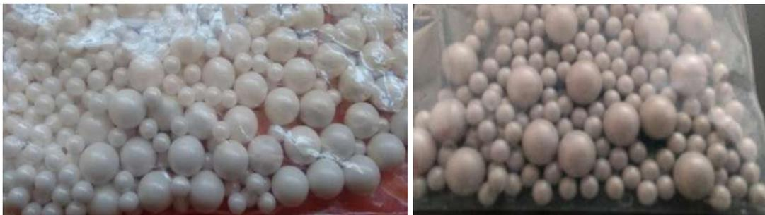
Fig. 6.3 Bolas de óxido de zirconio estabilizados con itria.
