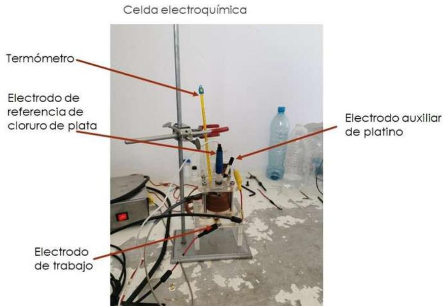
Fig.6.20 Celda electroquímica.
