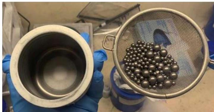
Fig. 6.2 Jarro y Bolas recubiertas con titanio.
