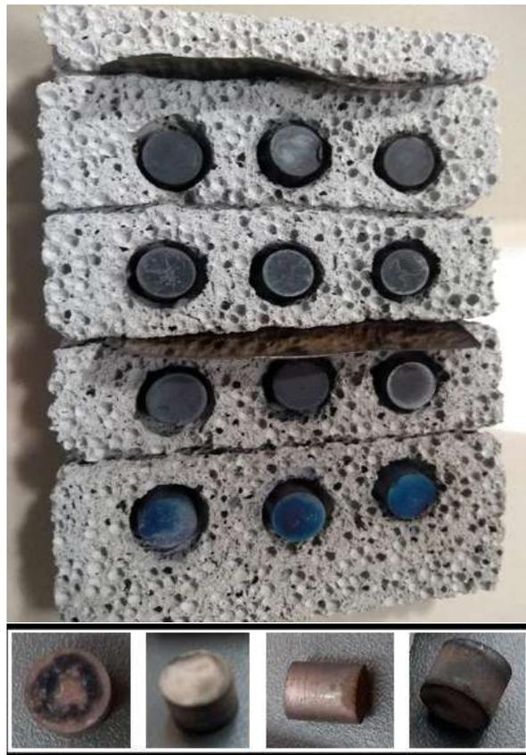
Fig. 7.10 Espumas sinterizadas
