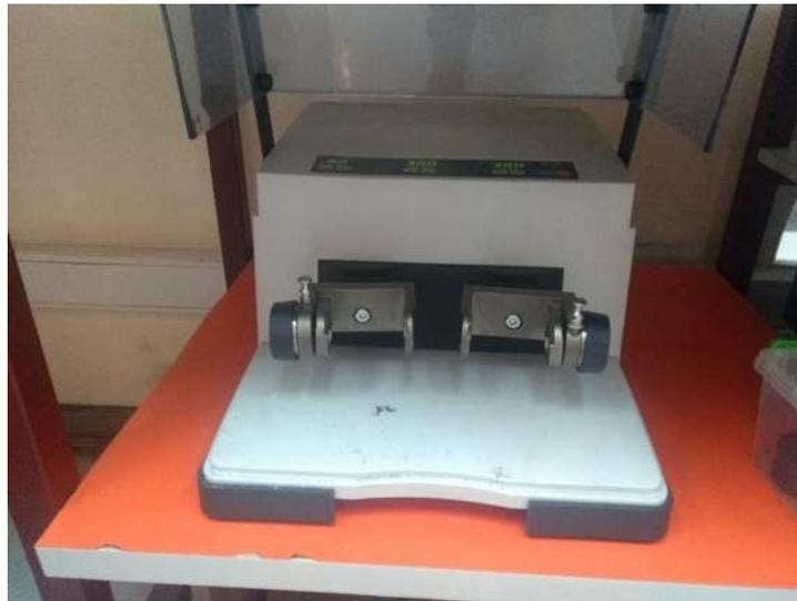
Fig. 6.10 Mezclador de Polvos RETSCH modelo MM 400.
