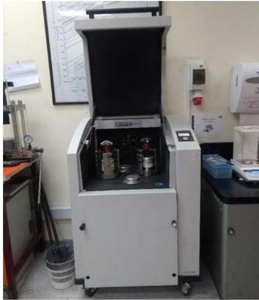
Fig. 6.6 Molino planetario Retsch PM 400.
