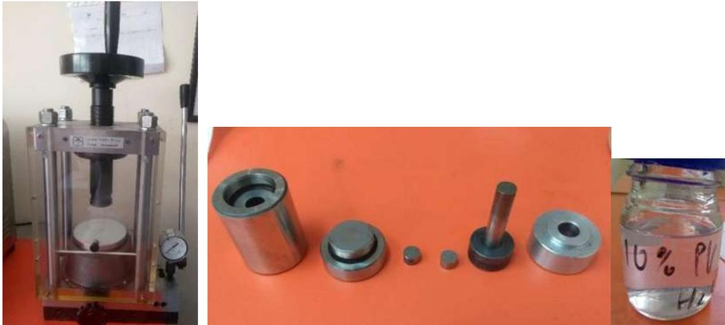
Fig. 6.9 Máquina de Compactación Zwick/Roell modelo Z030 y matriz y Polivinil PVA a 10% H<sub>2</sub>O.
