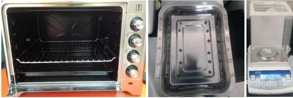
Fig. 6.15 Medición masa seca.
