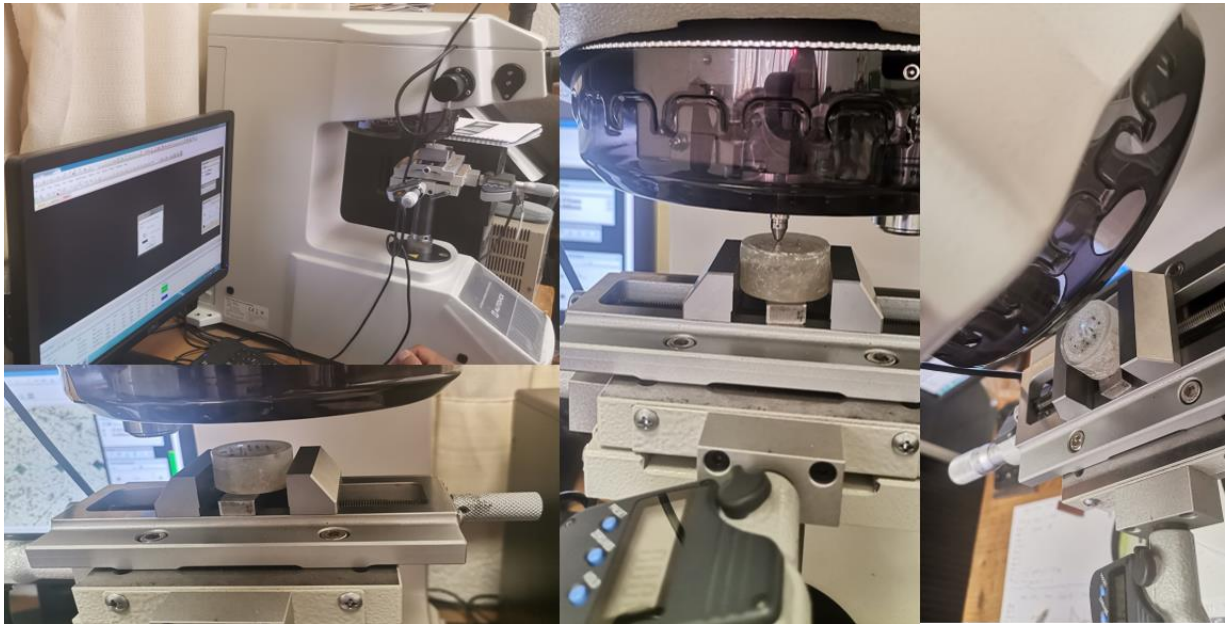
Fig. 21 Identación de las muestras con aparato Microdurómetro de Vickers Autovick® Mitutoyo HM-200. Fotografía tomada en el laboratorio del Instituto de Investigación en Metalurgia y Materiales de la U.M.S.N.H. Imagen propia
