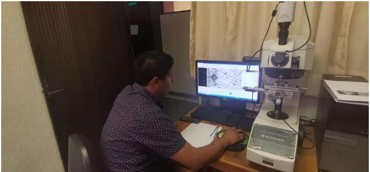
Fig. 25 Laboratorio e indentador Vickers Autovick® Mitutoyo HM-200. Fotografía tomada en el laboratorio del Instituto de Investigación en Metalurgia y Materiales de la U.M.S.N.H. Imagen propia.
