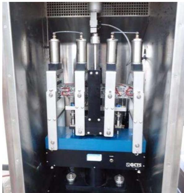
*Figura 29 Fatiga a cuatro puntos*
