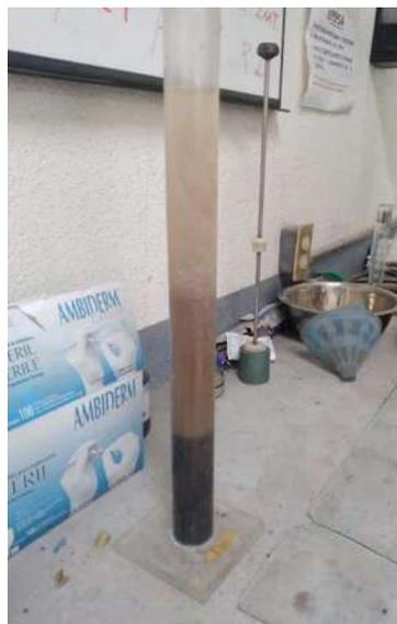
Figura 10 Probeta de equivalente de arena
