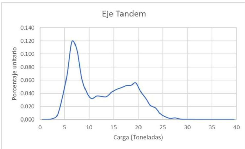
Gráfica 9 Espectro de carga para un eje tandem
