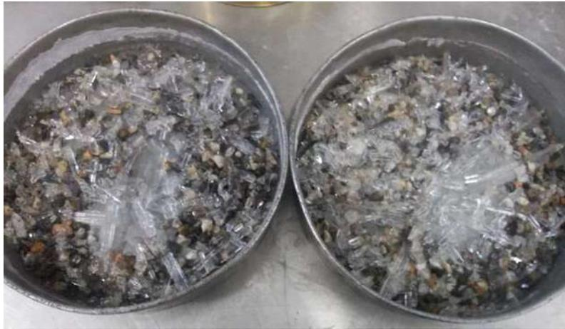
*Figura 3 prueba de intemperismo acelerado*
