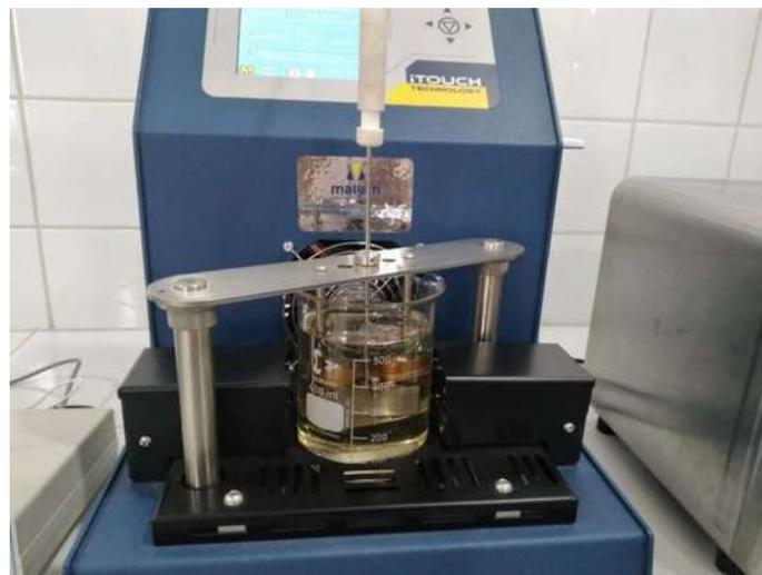
*Figura 26 Realización de prueba separación anillo esfera*
