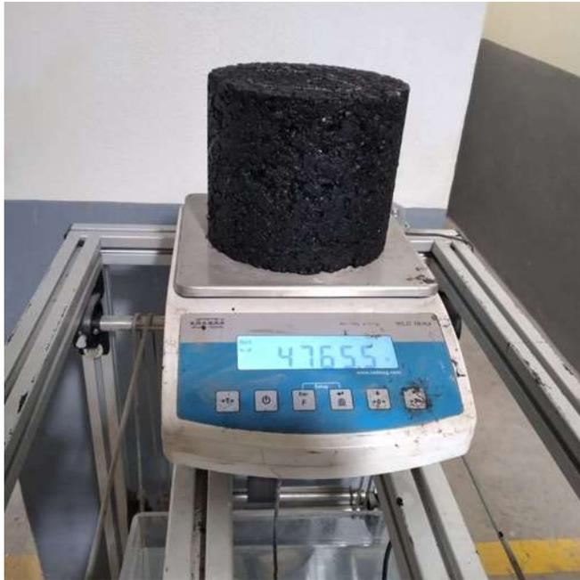
Figura 48 Pastilla de mezcla asfáltica para diseño
