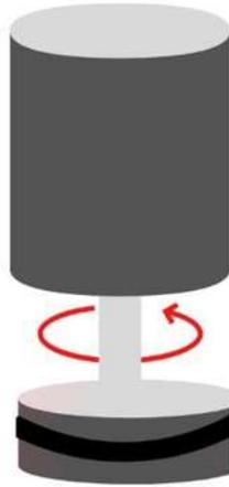
*Figura 21 Funcionamiento del reómetro de corte dinámico*
