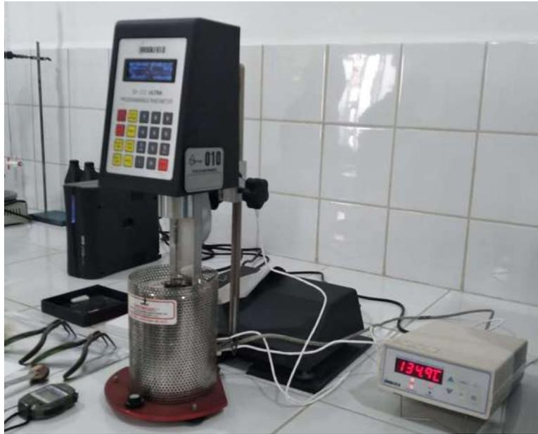
*Figura 19 Viscosímetro rotacional*
