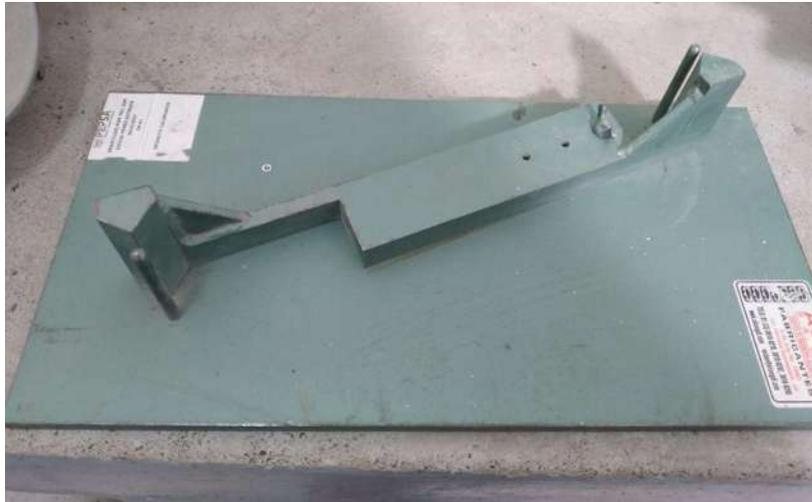
*Figura 4 calibrador ASTM para prueba de forma de la partícula*
