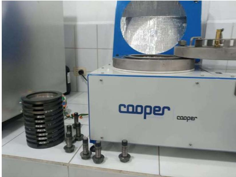
*Figura 23 Horno PAV*
