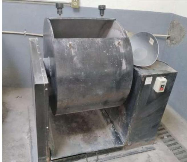
*Figura 1 máquina de desgaste de los Ángeles*
