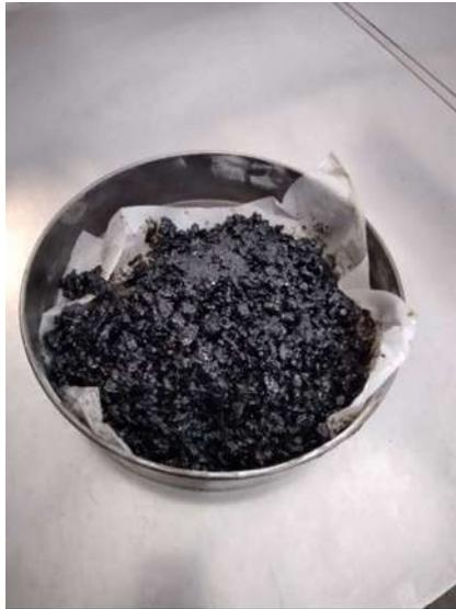
*Figura 16 Mezcla asfáltica*
