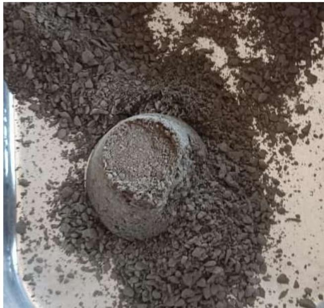
*Figura 6 Condición SSS agregado fino*
