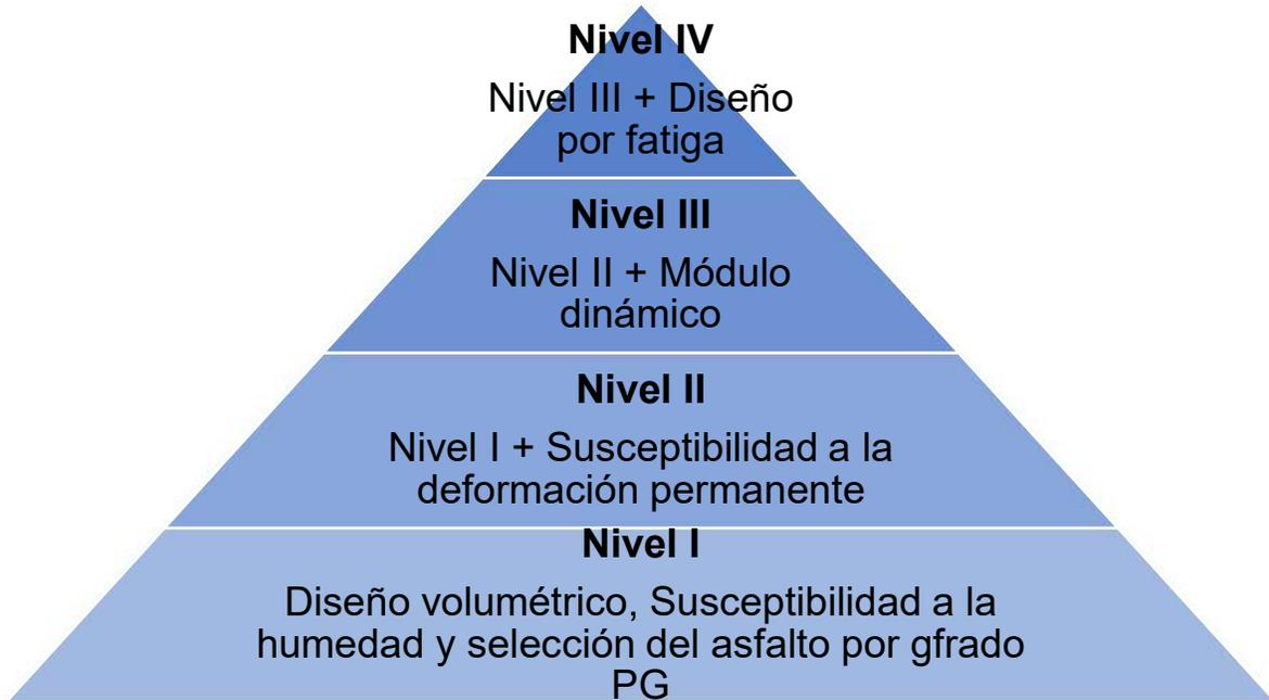
*Figura 15 Niveles de diseño para mezclas asfálticas por protocolo AMAAC*
