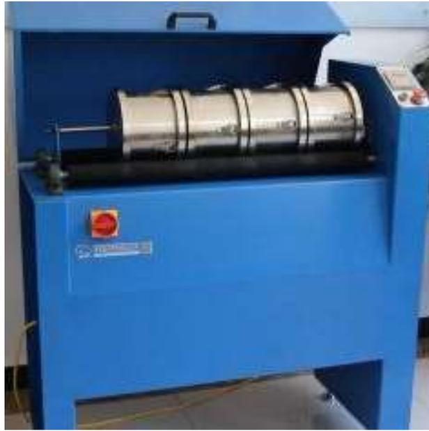
*Figura 2 máquina de desgaste microdeval*
