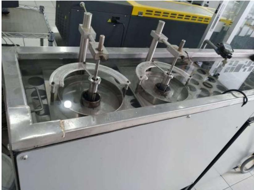
*Figura 24 Equipo de recuperación elástica por torsión*
