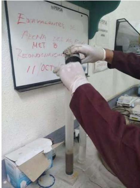
Figura 9 Realización de la prueba equivalente de arena
