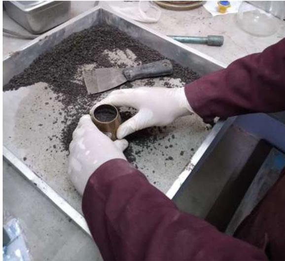
*Figura 5 Realización de prueba de gravedad específica y absorción del agregado fino*
