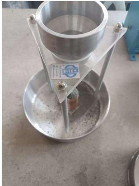
*Figura 7 Prueba angularidad del fino*
