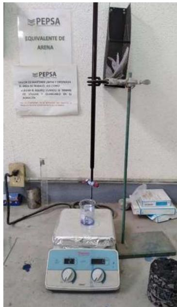
*Figura 11 Equipo de azul de metileno*
