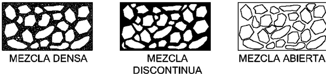
*Figura 35 Tipos de mezclas asfálticas*
