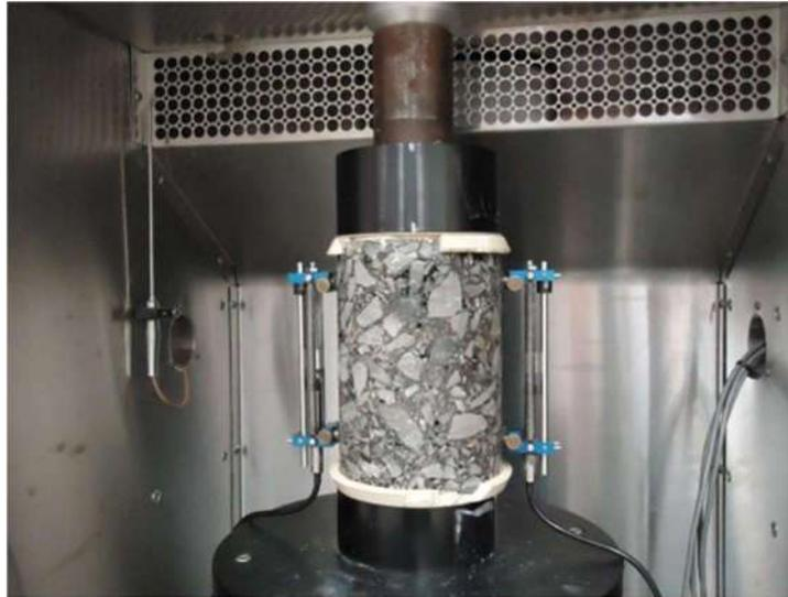
*Figura 36 Prueba de módulo dinámico*
