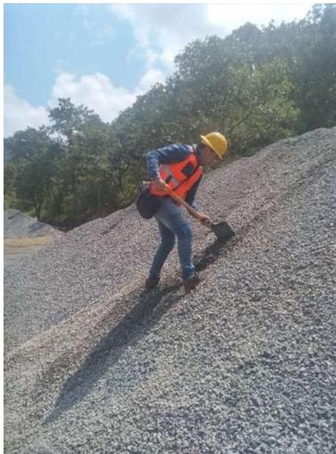
*Figura 45 Muestreo de agregado*
