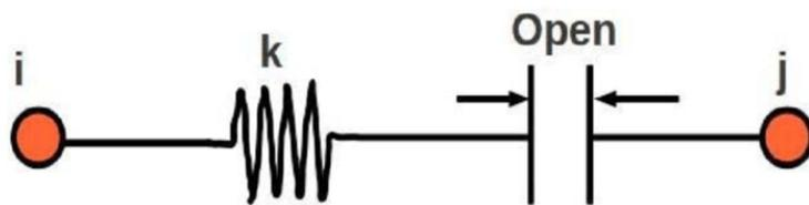
*Figura 4-6. Esquema de elemento gap*
