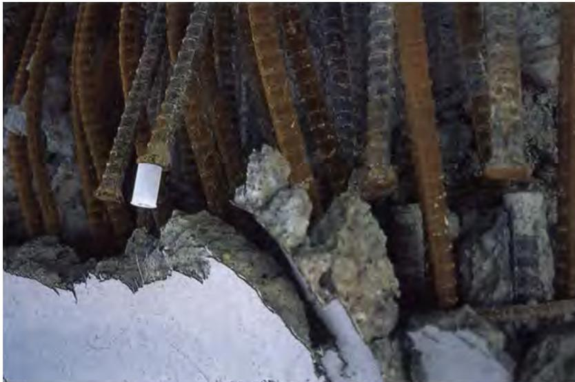
*Figura 1-2. Falla de empalmes soldados a presión de gas en pila de puente (Ghoshk 1995)*
