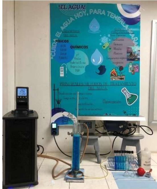
Reactor de Columna de Vidrio para el Proceso de Ozonización
