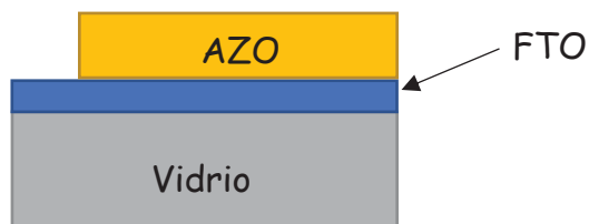
Figura 22. Esquema de depósito de las películas delgadas de ZnO:Al
