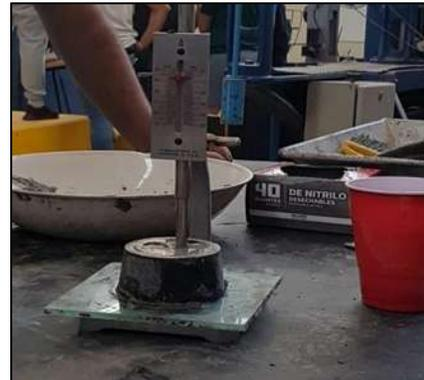
Figura 66.- Lectura de penetración del aparato de Vicat. (Contreras, 2023)
