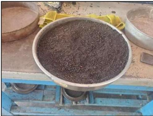
Figura 25.- Arena saturada con agua.
