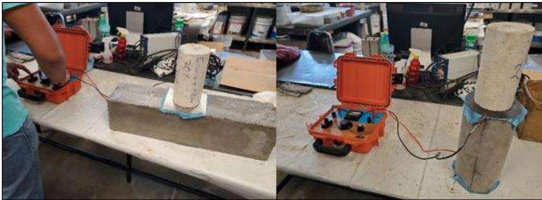
Figura 88.- Obtención de la resistencia eléctrica en vigas y cilindros. (Contreras, 2023)
