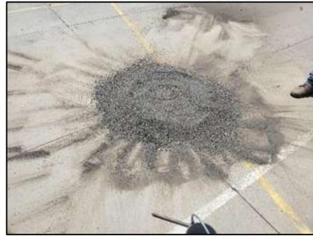
Figura 16.- Aplanado de la parte superior del montículo de arena, por medio de la pala. (Contreras, 2023)
