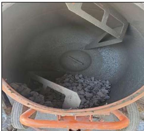
Figura 77.- 10% del agua con todo el agregado grueso. (Contreras, 2023)
