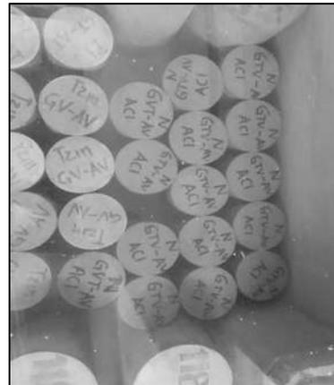
Figura 81.- Curado de los especímenes en la pila de curado para evitar la pérdida de humedad. (Contreras, 2023)
