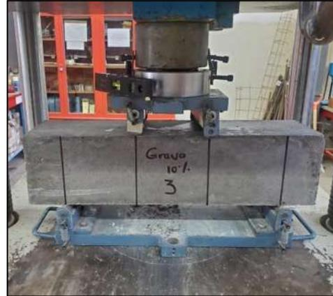
Figura 100.- Espécimen en los aditamentos y centrado en la máquina de pruebas. (Contreras, 2023)
