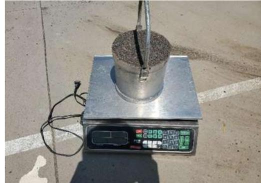
Figura 24.- Obtención de la masa de la arena con el recipiente. (Contreras, 2023)
