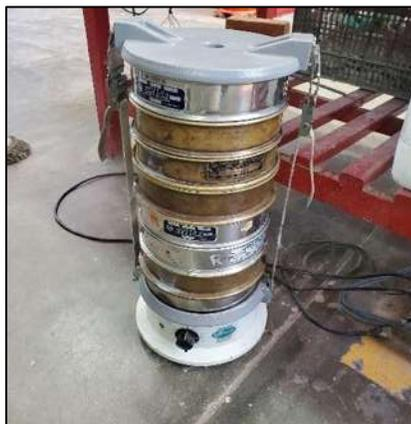
Figura 33.- Agitado de las mallas por medio de dispositivo mecánico (Raf-tap). (Contreras, 2023)
