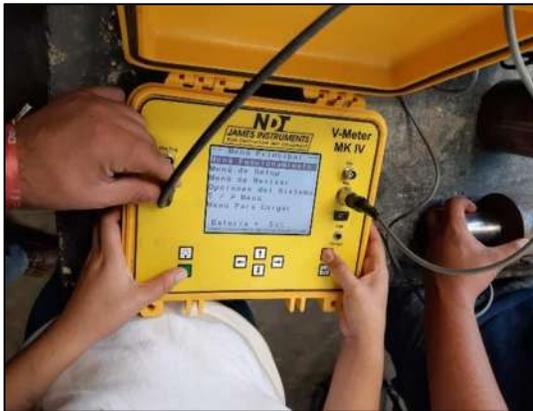
Figura 90.- Equipo de VPU conectado y calibración de transductores. (Contreras, 2023)
