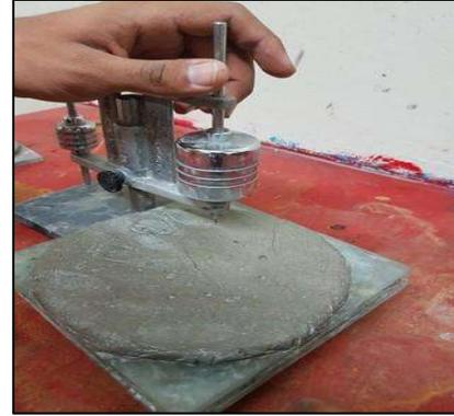
Figura 68.- Determinación del fraguado final con la aguja más pesada del aparato de Gillmore. (Contreras, 2023)
