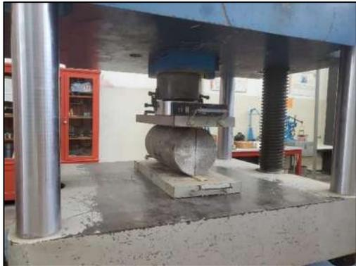
Figura 97.- *Espécimen centrado entre las placa de acero y las tiras de triplay. (Contreras, 2023)*
