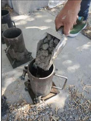
Figura 80.- Vaciado de la mezcla de concreto en los especímenes cilíndricos de 10x20cm. (Contreras, 2023)
