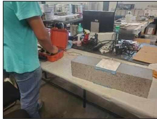
Figura 86.- Placas metálicas conectadas al resistómetro. (Contreras, 2023)
