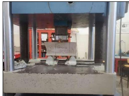
Figura 115.- Mitad de viga en la máquina de pruebas para fallarla transversalmente. (Contreras, 2023)
