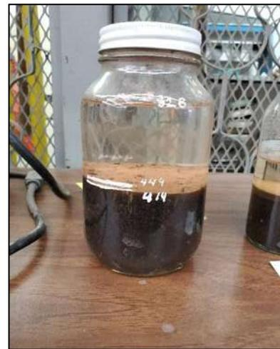
Figura 40.- Después de 24 horas se observa si el material fino rebasa o no la marca de 444 ml. (Contreras, 2023)
