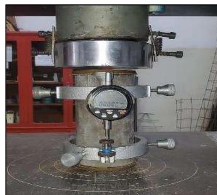
Figura 95.- Verificando el correcto funcionamiento del micrómetro. (Contreras, 2023)
