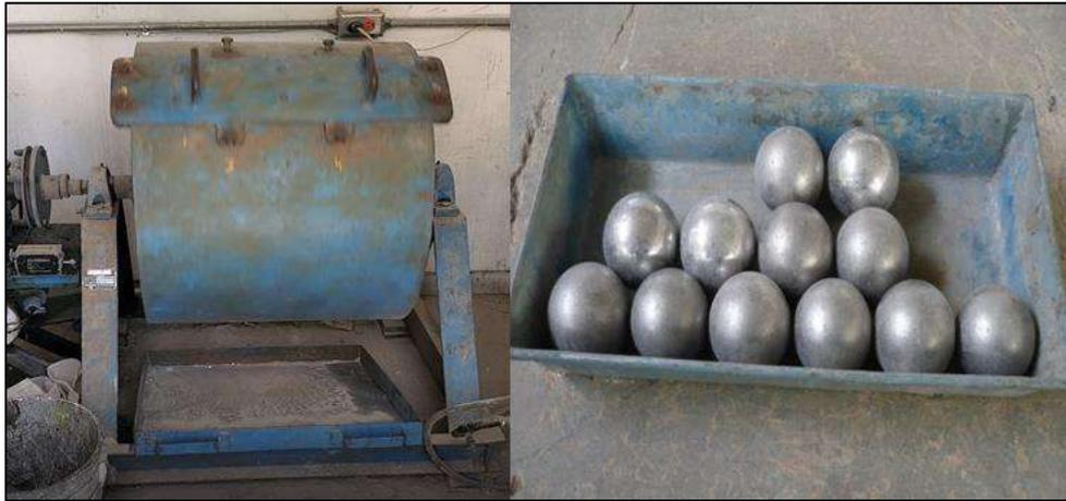
Figura 58.- Máquina de los Ángeles y esferas de acero. (Contreras, 2023)
