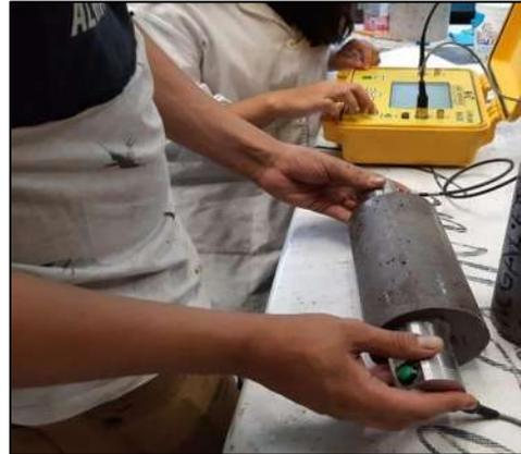
Figura 89.- Transductores en las caras de la muestra para la obtención de la VPU. (Contreras, 2023)
