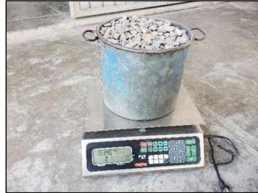
Figura 48.- Masa del recipiente más el peso del material compactado. (Contreras, 2023)
