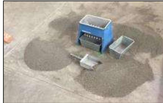
Figura 14.- Cuarteado del agregado fino por el método A. (Contreras, 2023)
