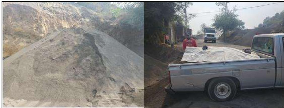
Figura 12.- Toma de muestra de material almacenado de arena del banco de material “Joyitas”. (Contreras, 2022)
