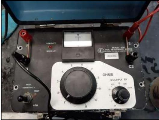
Figura 87.- Resistómetro Nilson punteado. (Contreras, 2023)
