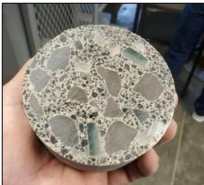
Figura 103.- Rodajas de concreto de 10 cm de diámetro por 5 cm de espesor. (Contreras, 2023)
