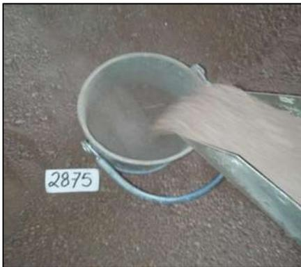
*Figura 19.- Vaciado de la arena en el recipiente con volumen y masa conocida. (Contreras, 2023)*
