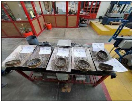
Figura 55.- Masa de la muestra para la granulometría. (Contreras, 2023)
