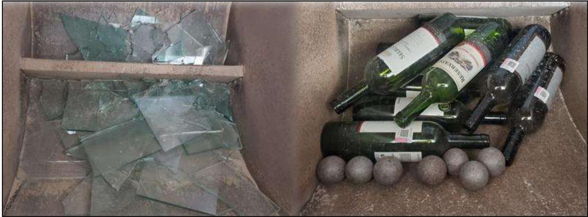
Figura 59.- Desechos de vidrio dentro de la máquina con las esferas de acero. (Contreras, 2023)
