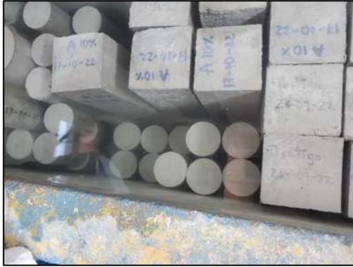
Figura 111.- Rodajas de concreto en la pila de curado para su saturado. (Contreras, 2023)
