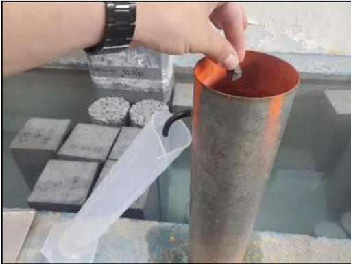
Figura 53.- Introduciendo el material dentro del picnómetro. (Contreras, 2023)
