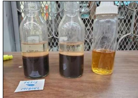
Figura 38.- Comparación del color del líquido de la botella con la solución normalizada. (Contreras, 2023)
