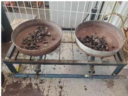
Figura 51.- Secado del material en la parrilla eléctrica. (Contreras, 2023)
