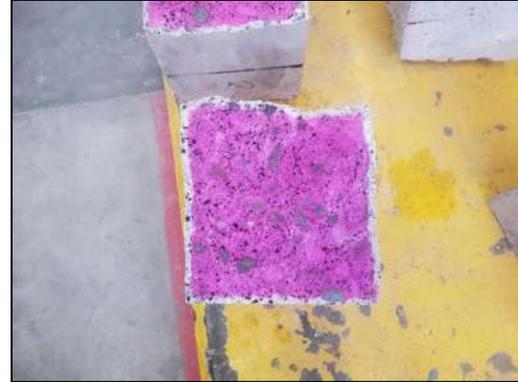
Figura 117.- Espécimen listo para la medición de la profundidad de carbonatación. (Contreras, 2023)
