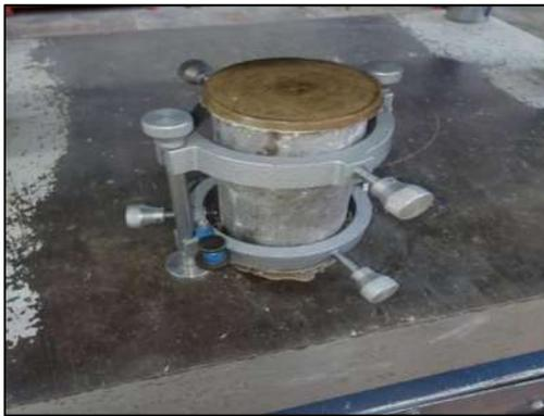
Figura 93.-.- Especimen con los dos anillos junto con las barras separadoras. (Contreras, 2023)
