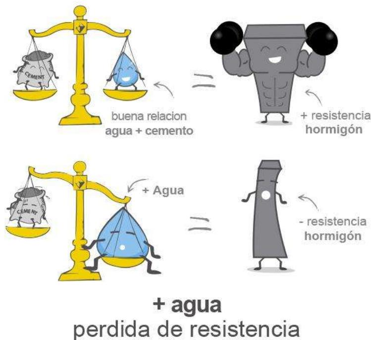
Figura 5.- Efecto de la cantidad de agua en la resistencia del concreto.
