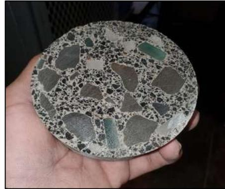
Figura 114.- Rodaja de concreto saturada y superficialmente seca. (Contreras, 2023)
