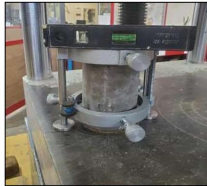
Figura 94.- Verificando la verticalidad con el nivel de burbuja. (Contreras, 2023)
