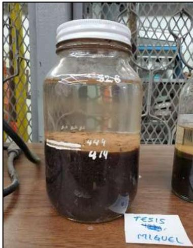
Figura 39.- Arena en la marca de los 414 ml y el agua en la marca de 828 ml. (Contreras, 2023)
