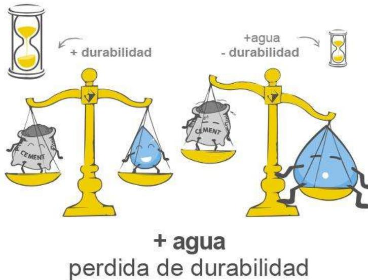
Figura 4.- La relación agua/cemento afecta la durabilidad del concreto. (Putzmeister, 2019)
