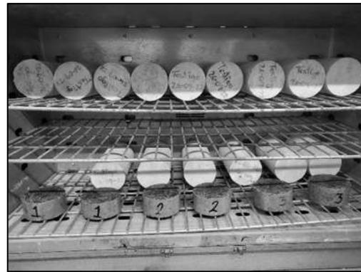
Figura 113.- Rodajas de concreto en el horno para su secado a 105 °C. (Contreras, 2023)
