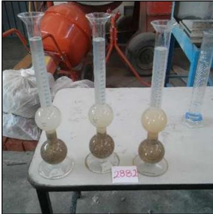
Figura 29.- Frasco con arena y agua, hasta la marca de 450 ml. (Contreras, 2023)
