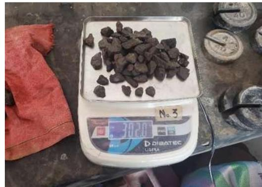
Figura 50.- Masa del material saturado y superficialmente seco. (Contreras, 2023)
