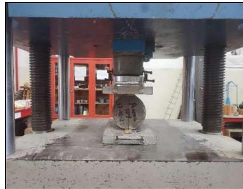
Figura 98.- *Aplicando carga hasta la falla del espécimen. (Contreras, 2023)*
