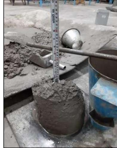
Figura 85.- Obtención del revenimiento de la mezcla de concreto fresco. (Contreras, 2023)
