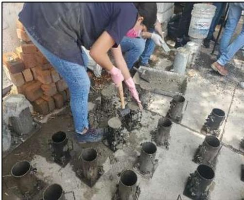
Figura 82.- Vibrado suave con mazo de goma para eliminar las oquedades. (Contreras, 2023)
