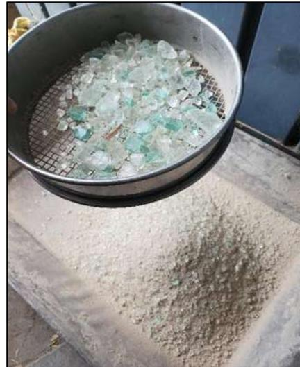
Figura 61.- Material pasado por la Malla #4 para obtener el vidrio molido. (Contreras, 2023)
