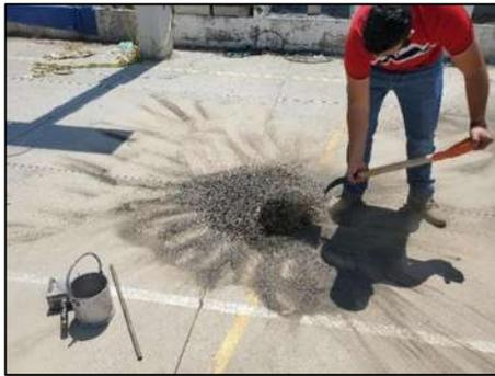
Figura 18.- Cambiando el material de un lado a otro por paleado. (Contreras, 2023)
