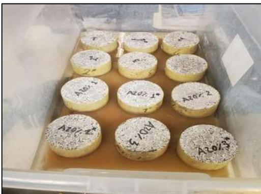
Figura 106.- Rodajas de concreto selladas en el recipiente con agua. (Contreras, 2023)
