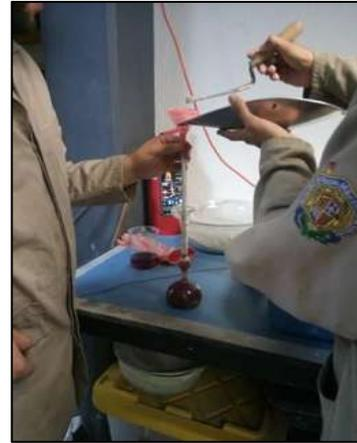
Figura 71.- Se introduce el cemento en el frasco para determinar su volumen. (Contreras, 2023)
