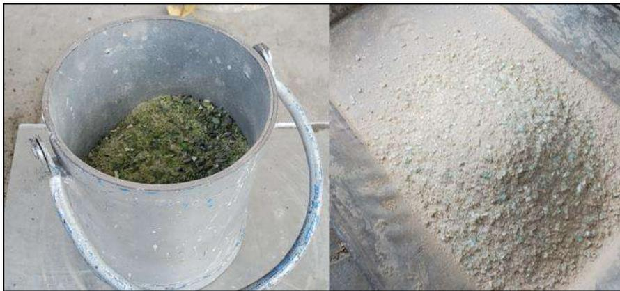
Figura 62.- Vidrio molido y de tamaño similar al agregado fino. (Contreras, 2023)
