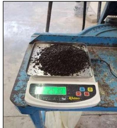
Figura 28.- Masa de la arena saturada y superficialmente seca. (Contreras, 2023)
