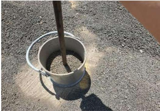
Figura 23.- Compactación de la arena con ayuda de la varilla punta de bala. (Contreras, 2023)
