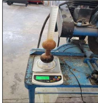
Figura 30.- Peso del frasco junto con la arena y el agua. (Contreras, 2023)
