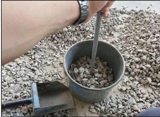
Figura 47.- Compactado del material con la varilla punta de bala. (Contreras, 2023)
