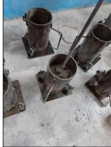
Figura 79.- Varillado de los especímenes con la varilla de 3/8". (Contreras, 2023)
