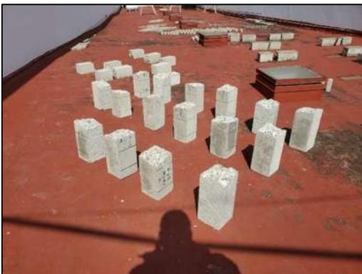
Figura 116.- Mitades de viga expuestas a la humedad del ambiente. (Contreras, 2023)
