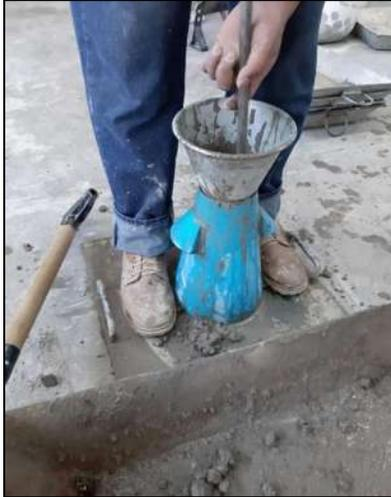
Figura 83.- Figura 84.- Compactación de cada capa 25 veces con la varilla. (Contreras, 2023)
