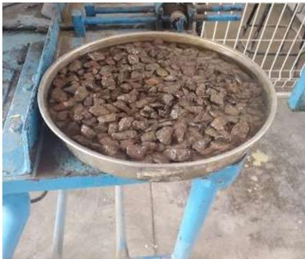
Figura 49.- Muestra de grava saturada en agua durante 24 horas. (Contreras, 2023)
