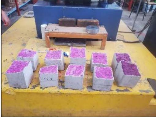
Figura 118.- Espécimen ya con la solución indicadora ácido-base. (Contreras, 2023)
