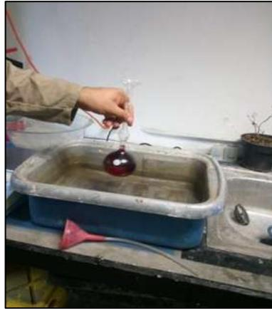
Figura 72.- Recipiente con agua, para mantener la temperatura constante durante la prueba. (Contreras, 2023)
