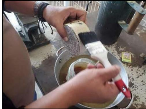
Figura 107.- Sellado de las rodajas de concreto con la parafina y brea.. (Contreras, 2023)
