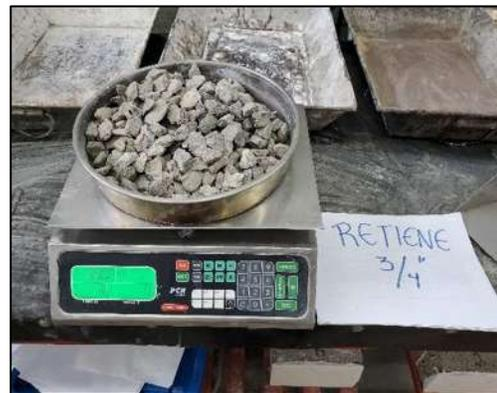
Figura 56.- Obtención del peso del material retenido en las mallas. (Contreras, 2023)
