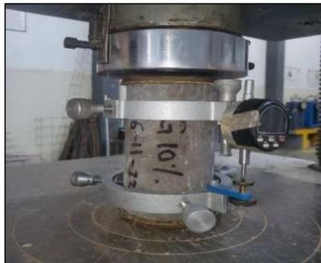
Figura 96.- Micrómetro colocado en los anillos. (Contreras, 2023)
