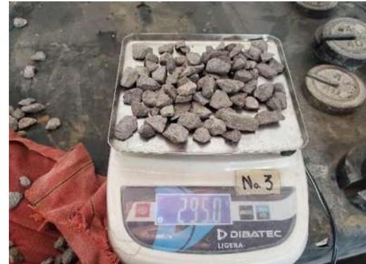
Figura 52.- Masa del material completamente seco. (Contreras, 2023)
