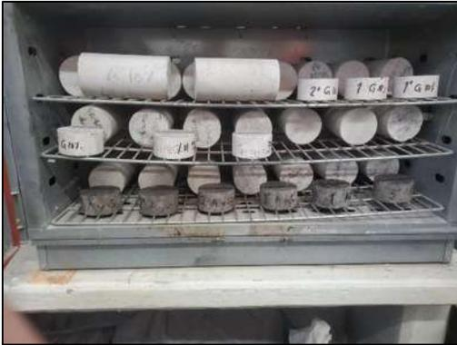
Figura 109.- Rodajas de concreto en el horno de secado. (Contreras, 2023)
