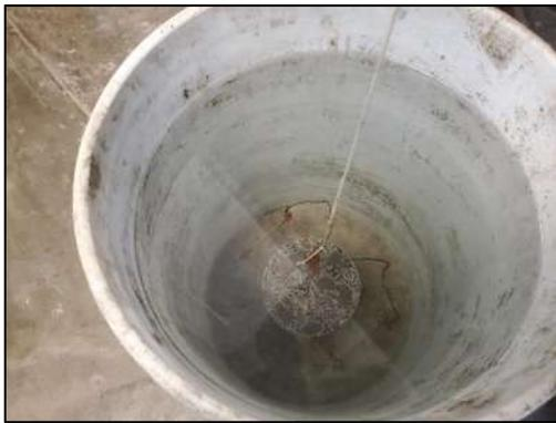
Figura 112.- Muestra de concreto sumergida con la canastilla. (Contreras, 2023)
