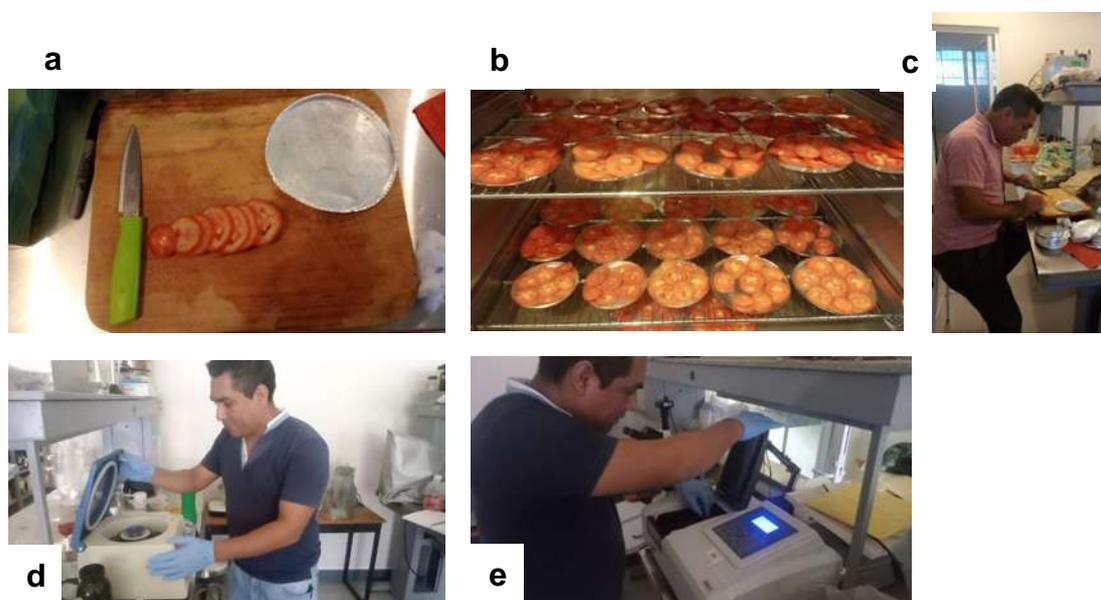
**Figura 3.17.** Medición del licopeno de los frutos. **a**, corte en rodajas; **b**, secado; **c**, maceración de los cortes secos; **d**, centrifugado de las muestras; **e**, lecturas de las muestras en un espectrofotómetro.
