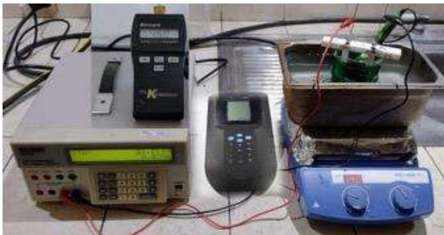
**Figura 3.3** Arreglo experimental para la electrodeposición de películas Ni-Co.
