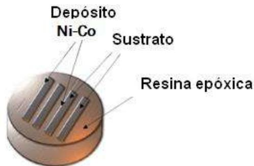
**Figura 3.4** Cortes transversales de sustratos con recubrimiento Ni–Co en resina epoxi.
