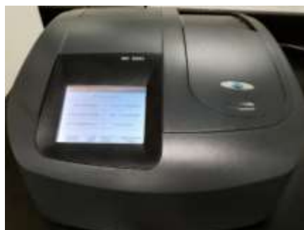
Figura 3.8. Espectrofotómetro DR 5000. Fuente: Propia.
