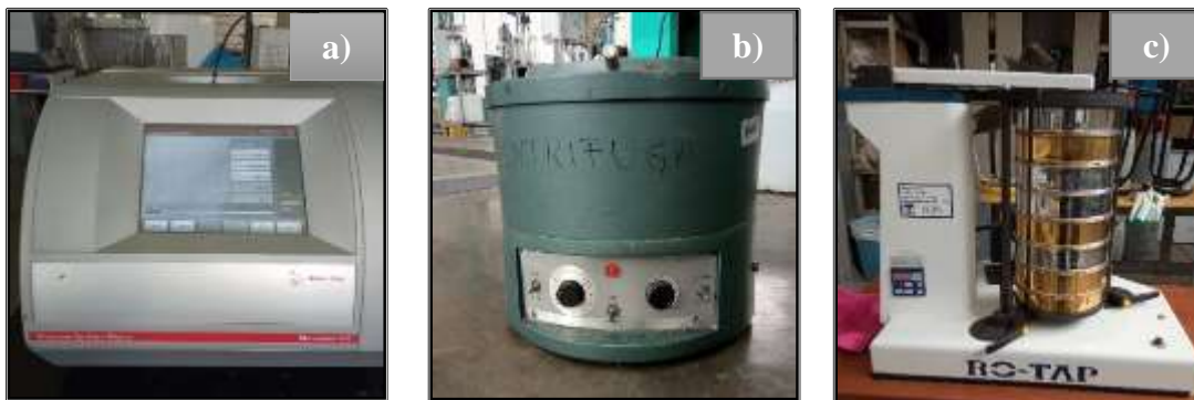
Figura 3.3. a) Reactor de microondas, b) Centrifuga Sol-Bat, c) Tamizador RO-TAP. Fuente: Propia.
