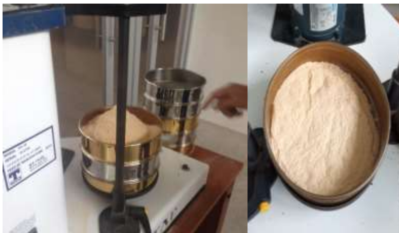
Figura 3.6. Tamizado a diferentes números de malla. Fuente: Propia.
