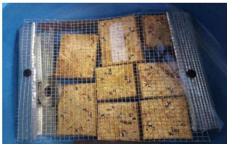
Figura 33. Proceso de inmersión para absorción de agua. Fuente: Elaboración propia.
