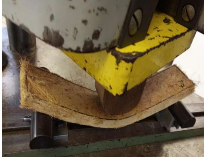
Figura 30. Ejecución flexión probeta T7. Fuente: Elaboración propia.
