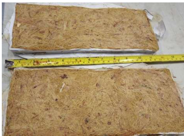
Figura 26. Caracterización dimensional de probetas para flexión. Fuente: Elaboración propia.
