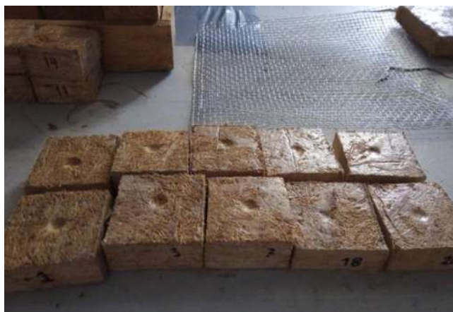
Figura 22. Muestras del material compuesto con prueba de dureza. Fuente: Elaboración propia.
