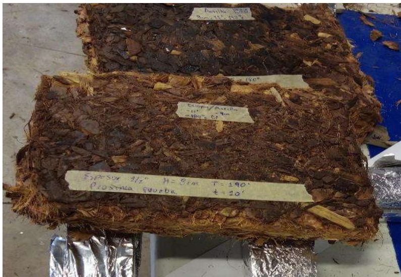
Figura 17. Defectos externos por proceso incorrecto. Fuente: Elaboración propia.
