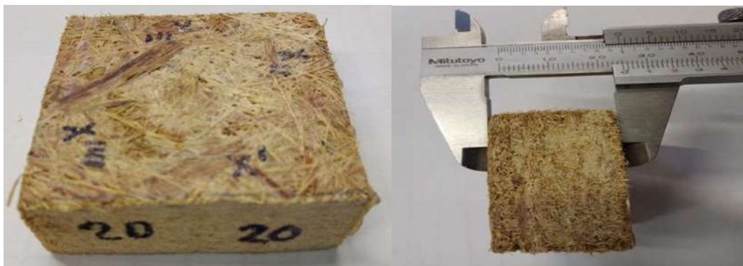
Figura 19. Caracterización dimensional para ensayo de dureza. Fuente: Elaboración propia.
