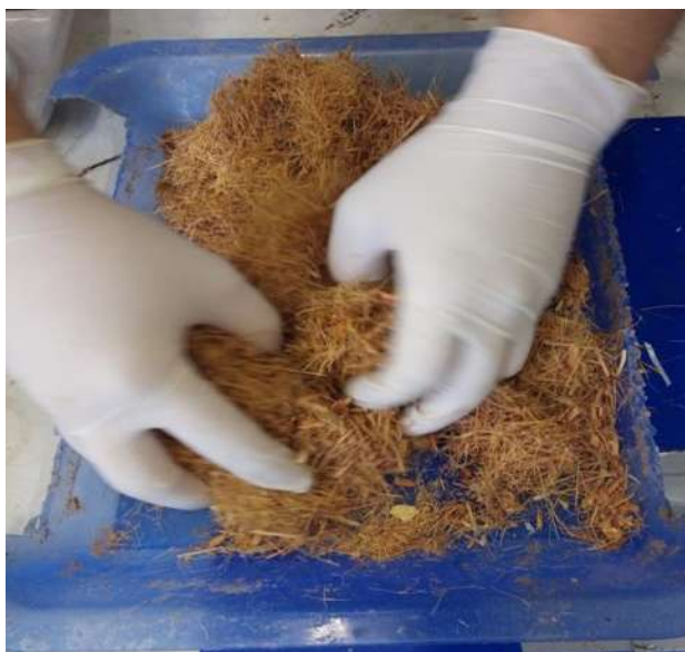
Figura 12. Preparación de compuesto resina UF - fibra de coco. Fuente: Elaboración propia.
