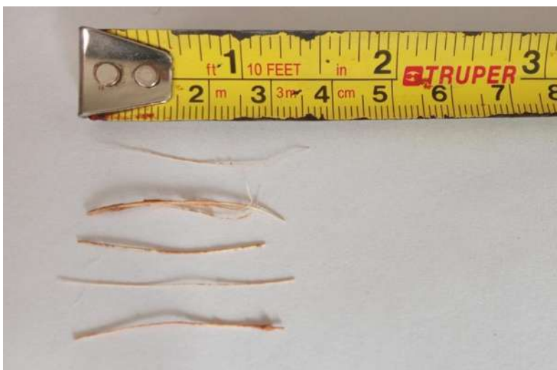
Figura 9. Caracterización dimensional de la fibra de coco. Fuente: Elaboración propia.
