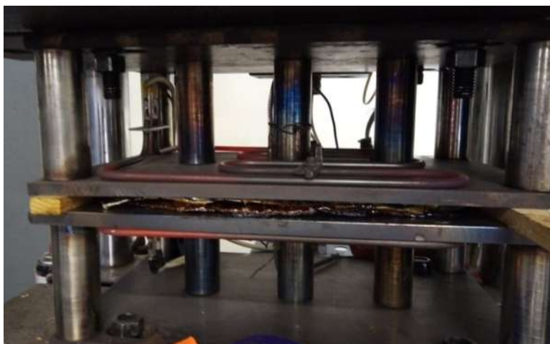
Figura 14. Proceso de prensado del material compuesto. Fuente: Elaboración propia.
