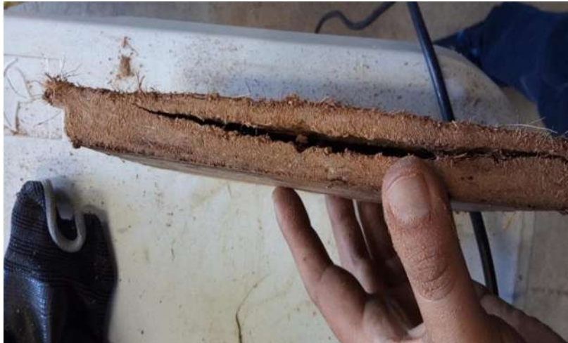
Figura 16. Defectos internos por proceso incorrecto. Fuente: Elaboración propia.
