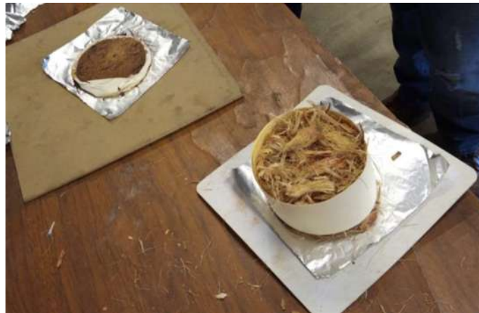
Figura 13. Colocación del material compuesto en contenedor. Fuente: Elaboración propia.
