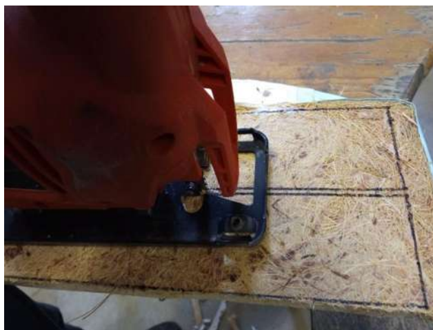
Figura 25. Obtención de probetas para flexión. Fuente: Elaboración propia.
