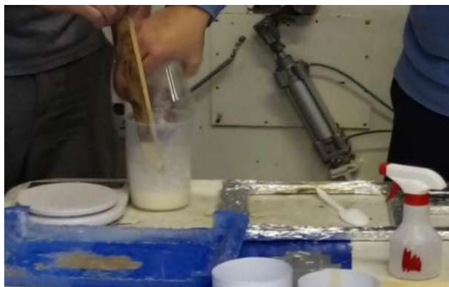
Figura 10. Preparación de la resina UF. Fuente: Elaboración propia.
