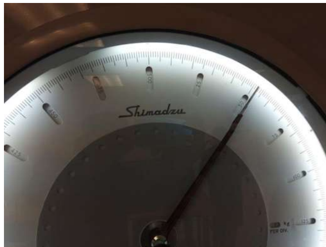
Figura 31. Obtención de valor de la fuerza de rompimiento. Fuente: Elaboración propia.
