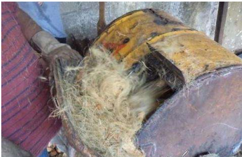
Figura 8. Procesado del mesocarpio para obtener la fibra. Fuente: Elaboración propia.
