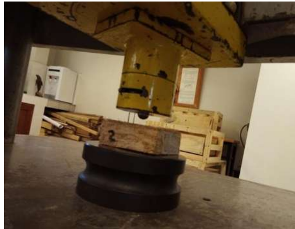
Figura 20. Aproximación del penetrador de dureza. Fuente: Elaboración propia.
