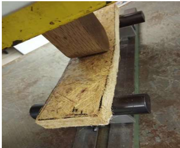
Figura 29. Ejecución flexión probeta T4. Fuente: Elaboración propia.
