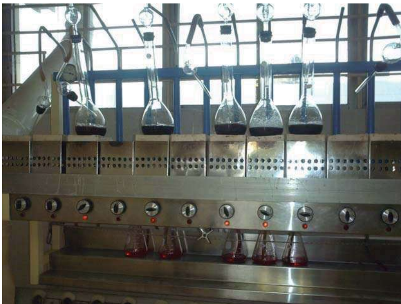
Fotografía de los procesos de digestión (arriba) y destilación en el hongo Shiitake para determinación de proteína en un Macrokjendhal
