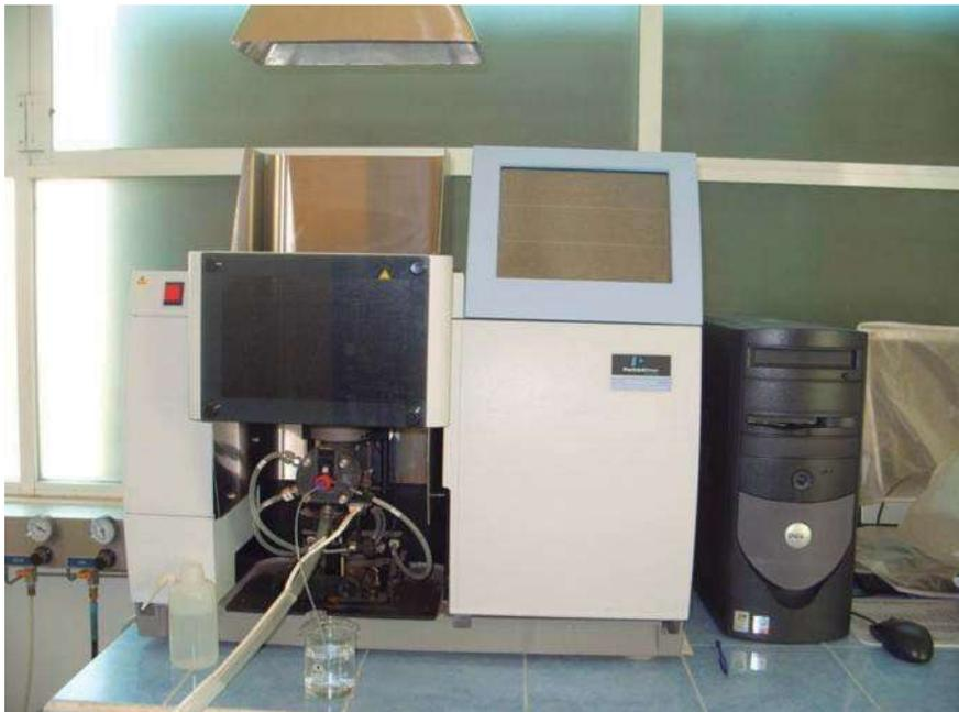
Fig.5 Espectrofotómetro de Absorción Atómica.
