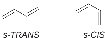
Figura 1.3. Conformaciones s-CIS y -TRANS del 1,3-butadieno.
