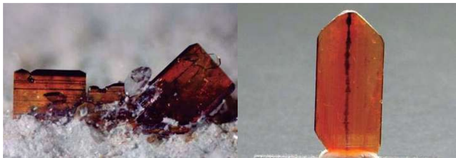
Figura 2.1.3 Representación de la molécula de dióxido de titanio en su forma cristalográfica natural, de estructura ortorómbica, brookita.
