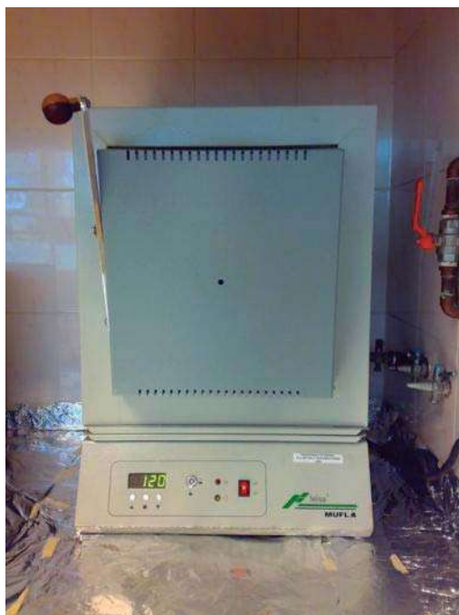
Fig. 21.- Mufla donde se llevo a cabo el secado y el calcinado de los precursores del \text{BaTiO}_3 .
