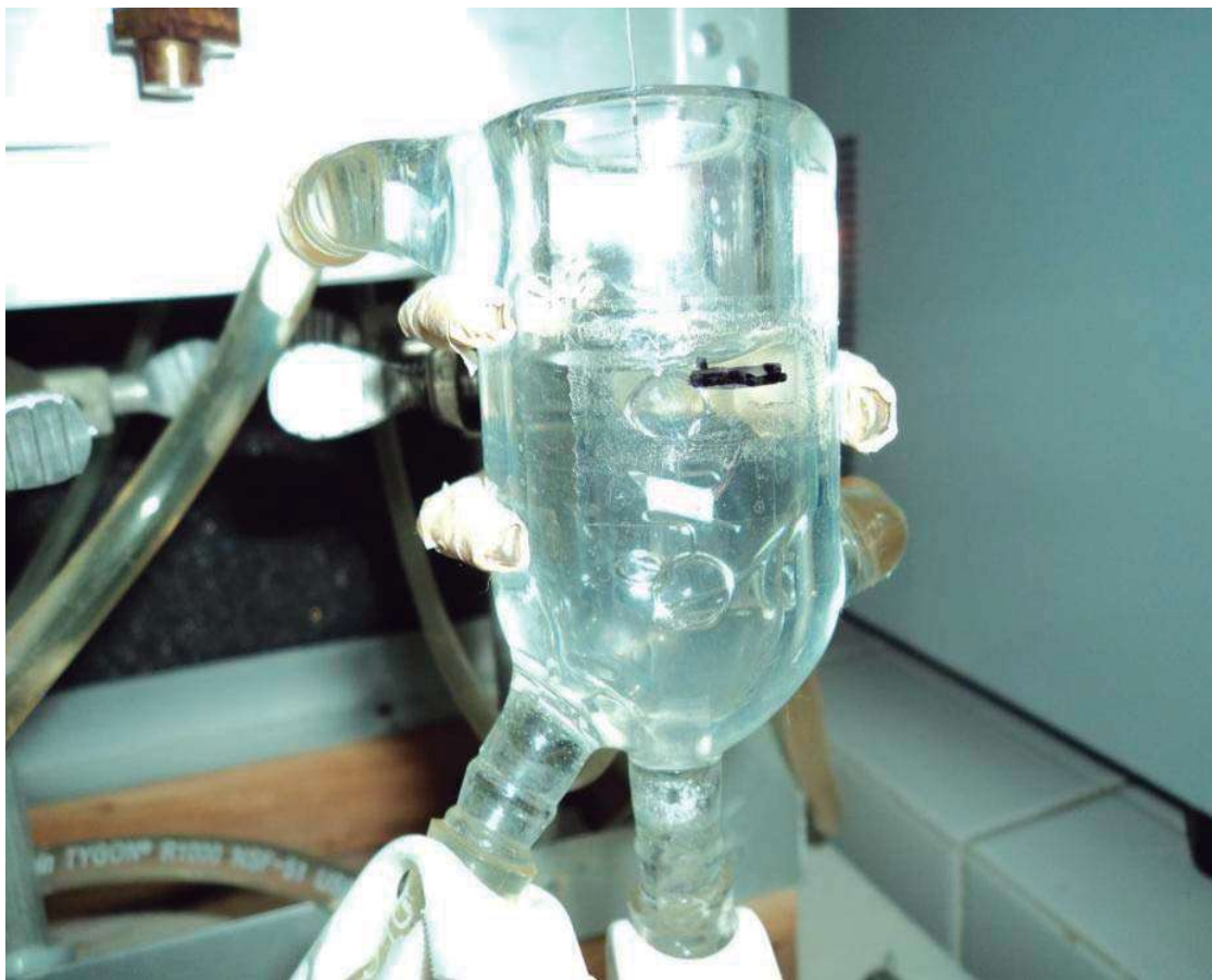
Figura 9.- Cámara para órgano aislado. En esta imagen se muestra un anillo de aorta sostenido con dos ganchos de níquel; con uno de estos ganchos se fijó la preparación al fondo de la cámara y con el otro gancho se fijó a un transductor de tensión.
