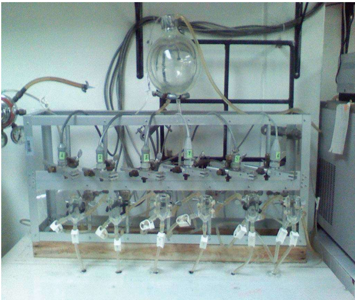
Figura 10.- Equipo para órgano aislado. En esta imagen se observan las cámaras para órgano aislado y los transductores de tensión. Adicionalmente se observa el matraz balón de doble fondo que suministra la solución Krebs.
