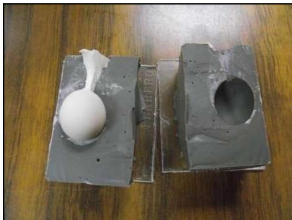
Figura 7. Molde de doble cara elaborado con caucho de Silicón. Se muestra un huevo de yeso recién desmoldado.
